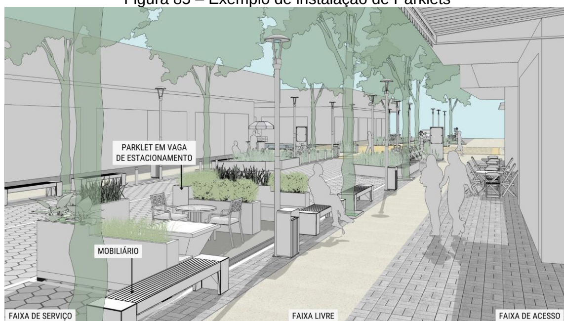
Figura 85 – Exemplo de instalação de Parklets
