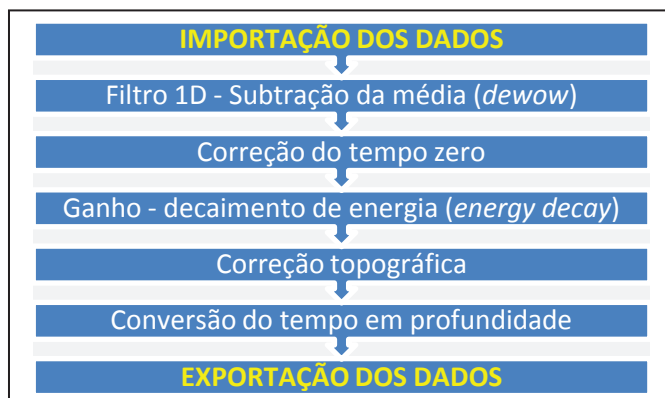
Figura 4.16 - Sequência de processamento dos dados das seções GPR – Adaptado de Rodrigues, 2004.
