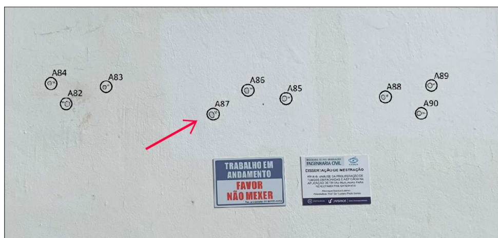
Figura 31 – Exemplo de localização dos pontos amostrados das películas das tintas
