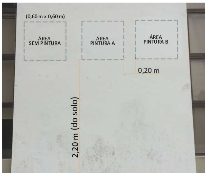
Figura 25 – Representação das áreas de trabalho demarcadas para realização dos procedimentos de repintura.
