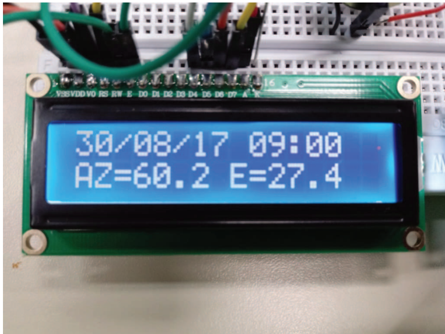
Figura 3-17 - Disposição dos dados em um display (LCD 16 x 2) com as respectivas informações de data hora , ângulo de azimuth e de elevação solar.
