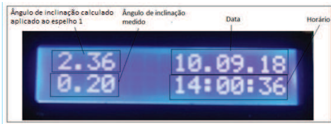
Figura 4-7 - Disposição do LCD da central de controle durante a medição da inclinação dos espelhos com o sensor de inclinação.
