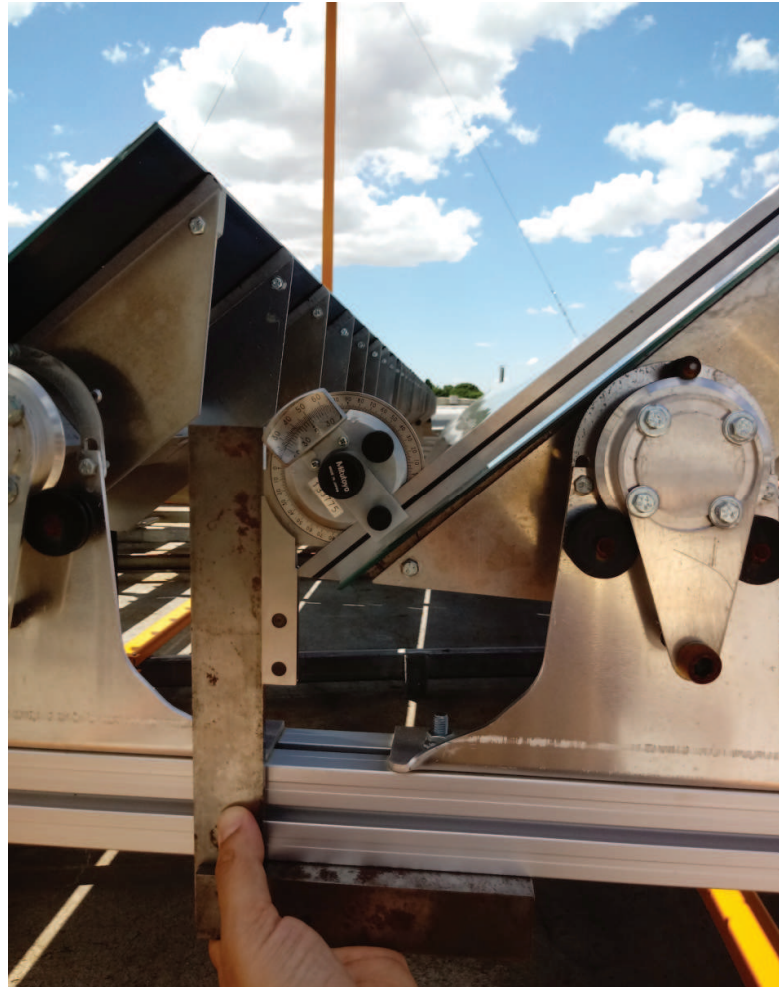
Figura 4-2 - Medição do ângulo de inclinação de cada espelho.
