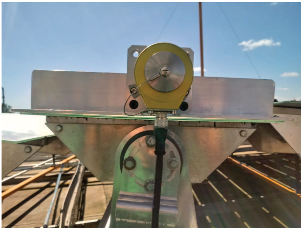
Figura 4-6 – Medição do ângulo \theta_n através do sensor de inclinação adaptado à cantoneira.
