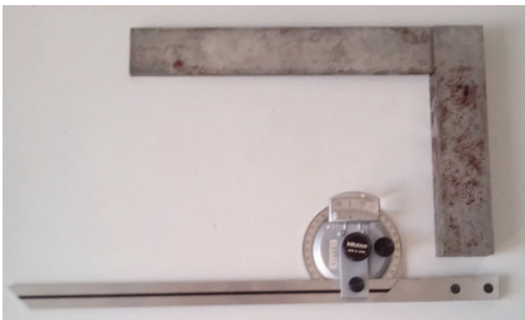
Figura 4-1 - Instrumentos usados para a verificação do ângulo de inclinação dos espelhos.
