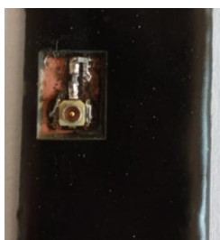
Figura 64 – Protótipo 1 encapsulado com acesso aberto para ajustes e medições.
