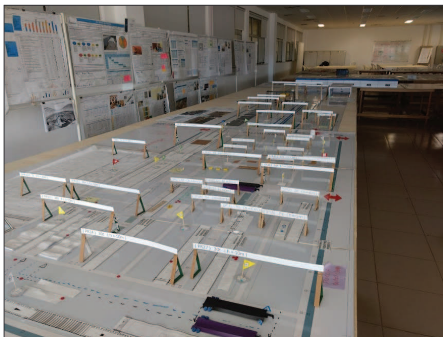
Figura 51 – Maquete dos setores de corte, submontagem e montagem de blocos
