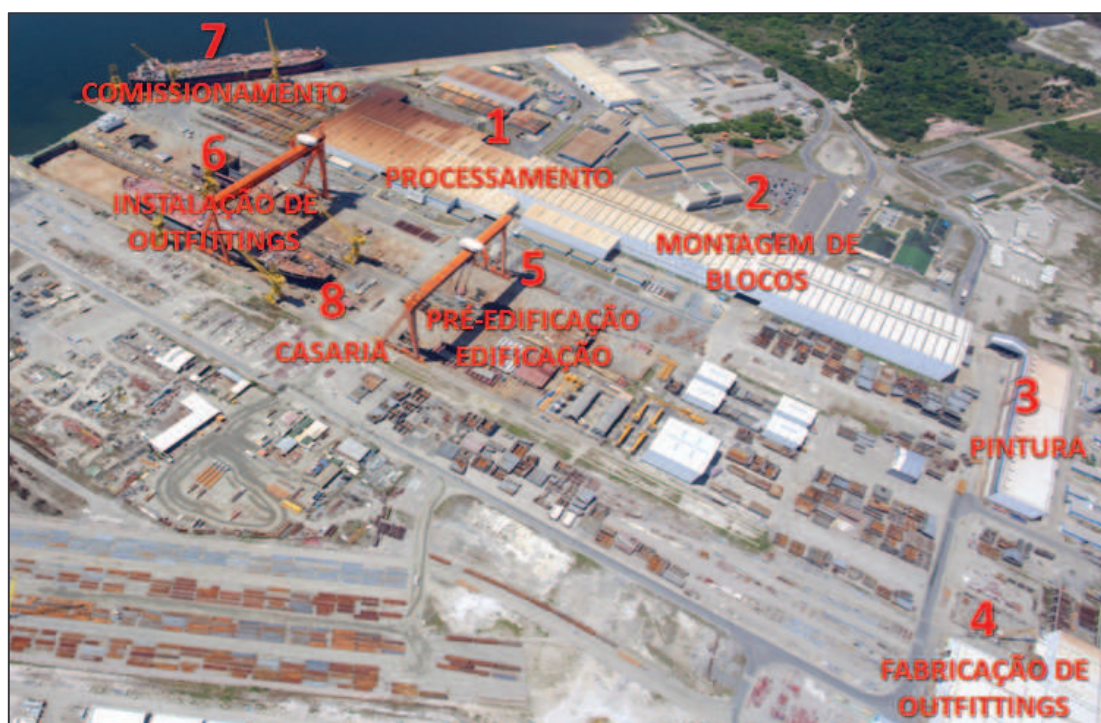
Figura 42 - Vista da nova estrutura de mini fábricas
