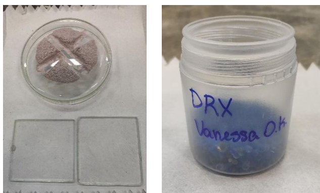
Figura 27 – Amostragem para ensaio de DRX e recipiente de armazenagem
