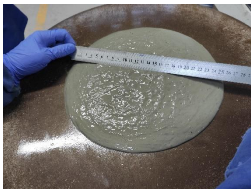
Figura 26 – Aspecto da pasta-base após ciclos de elevação e queda em mesa de abatimento
