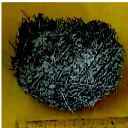
Figura 8 – Formação de grumos de fibras de aço devido a mistura incorreta do compósito
