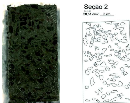
Figura 40 – Processo de quantificação do teor de agregados graúdos nas misturas analisadas
