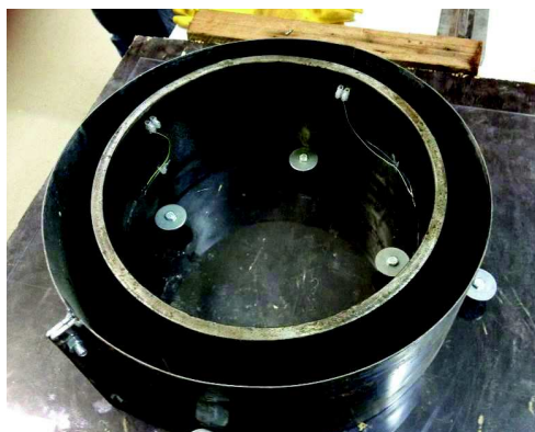
Figura 28 – Montagem do sistema de fôrmas para a confecção dos anéis de concreto
