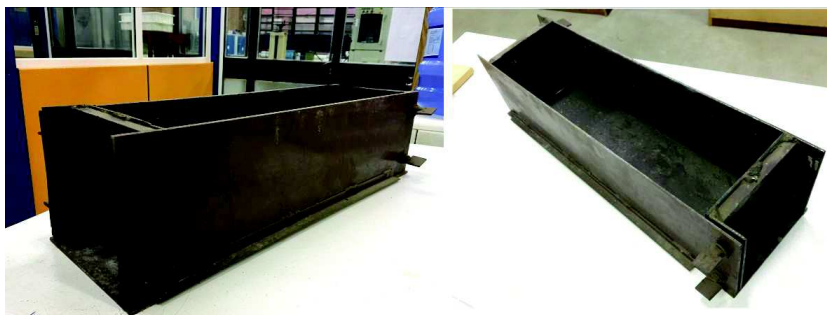
Figura 31 – Moldes para confecção das amostras prismáticas
