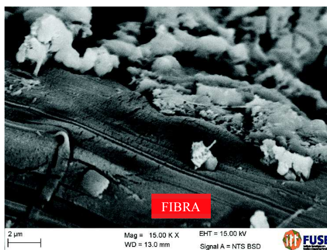
Figura 71 - Interface entre a microfibra de PVA e a matriz cimentícia
