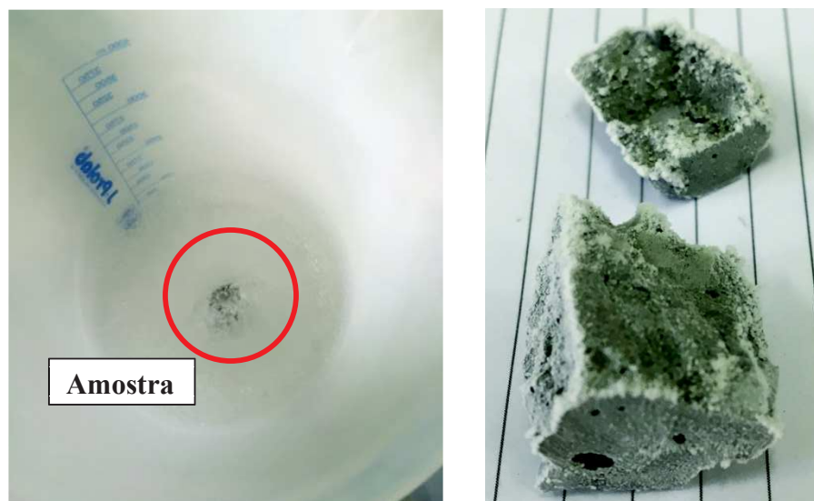
Figura 42 – Processo de criofratura nos concretos analisados
