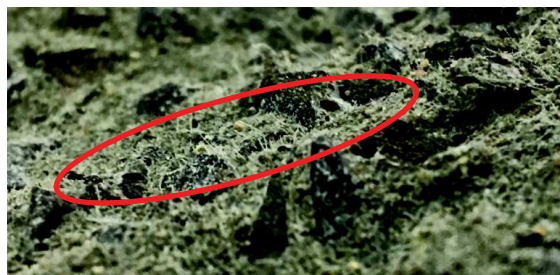
Figura 62 – Distribuição das microfibras de PVA e PP na matriz cimentícia
