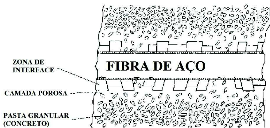
Figura 11 – Interface entre fibras de aço e matrizes cimentícias
