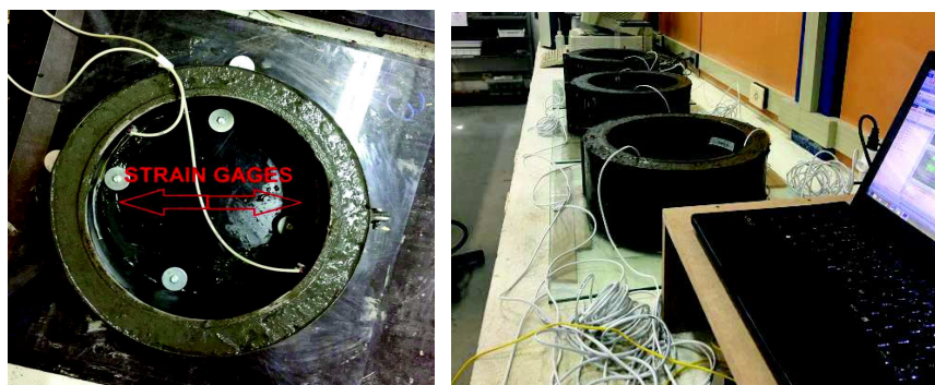
Figura 37 – Instrumentação completa do sistema de aquisição de dados
