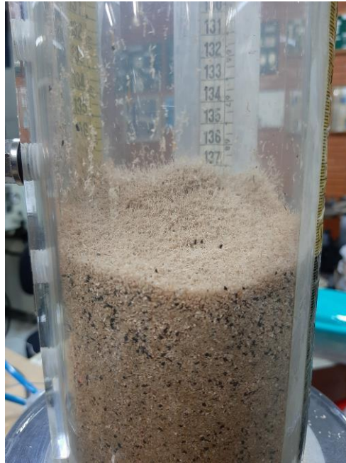
Figura 4-4 - Segregação de biomassa na superfície do leito (Mistura 15).
