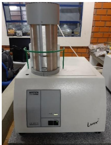
Figura 3-4 - Termobalança de precisão NETZSCH STA 409PC/PG.
