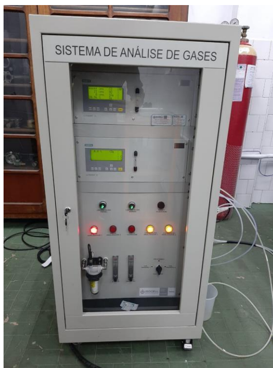
Figura 3-7 - Analisador de gases contínuo SIEMENS Ultramat 23.
