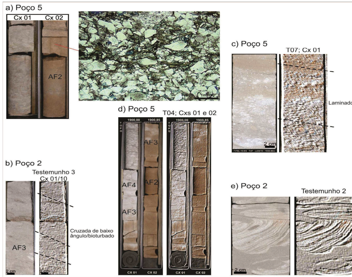
Figura 8 (a) Visão macro e microscópica de arenito médio, micáceo e mal selecionado da AF2; (b), (c), (d) e (e): pares de fotos de rochas siliciclásticas (AF2), híbridas (AF3) e carbonáticas (AF4) com aspecto maciço nas imagens sem tratamento (foto esquerda) e estratificado nas imagens submetidas à pseudo - iluminação (foto direita).
