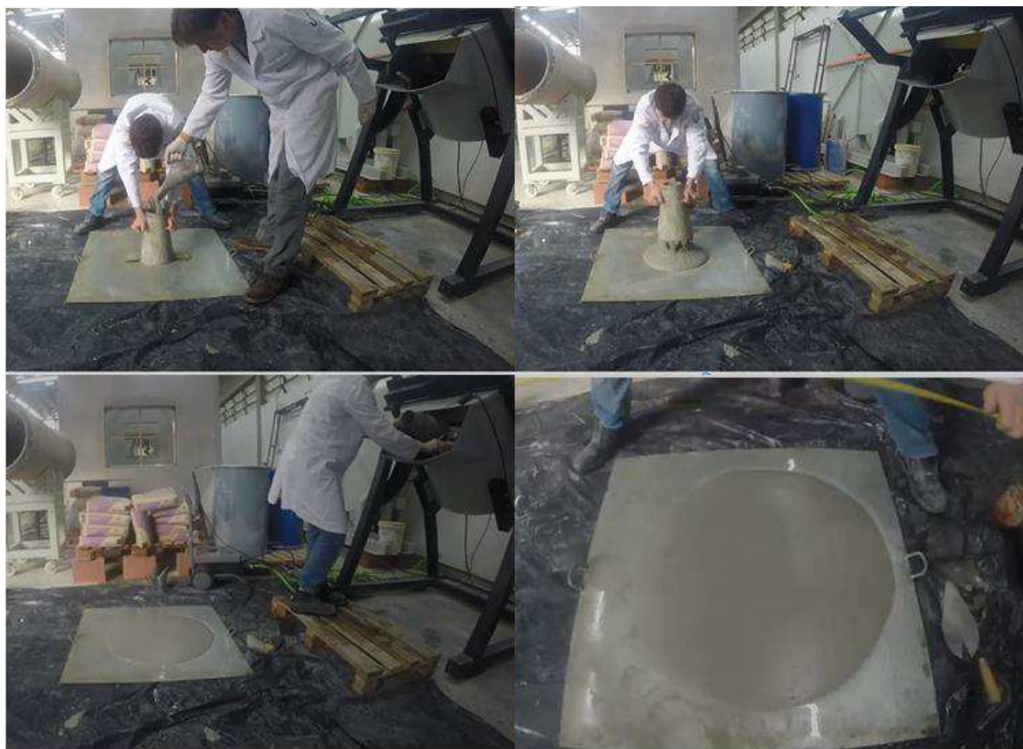
Figura 58 - Sequência do ensaio de espalhamento realizado em todas as misturas
