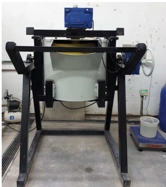
Figura 57 - Misturador planetário utilizado para a realização das misturas
