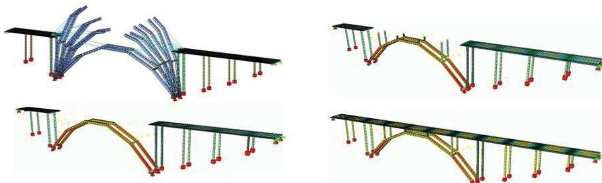
Figura 8 - Ilustração da sequência de montagem dos elementos que forma o arco
