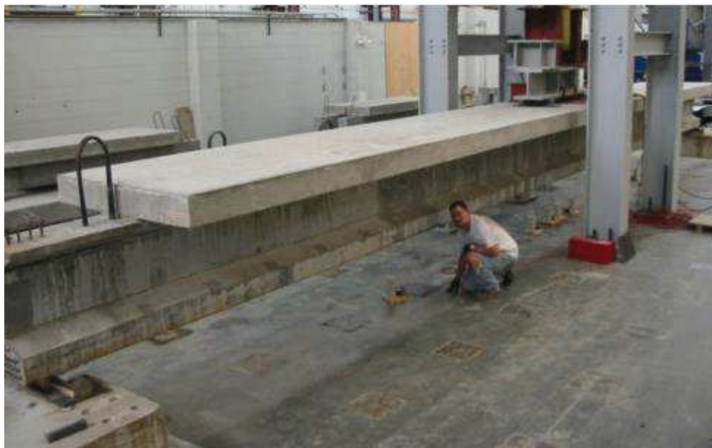
Figura 22 - Viga confeccionada com UHPC, sendo ensaiada em tamanho real
