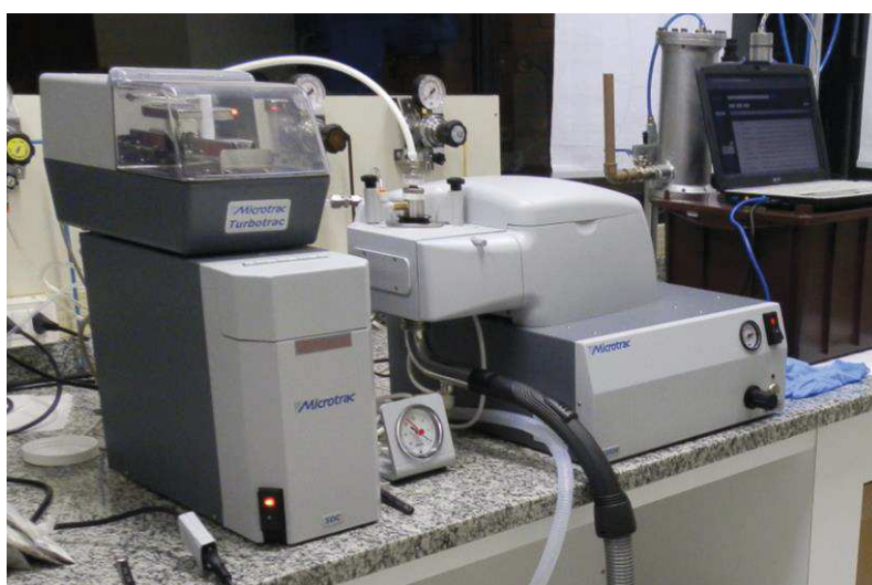
Figura 40 – Equipamento para verificação da granulometria a laser da Universidade do Vale do Rio do Sinos
