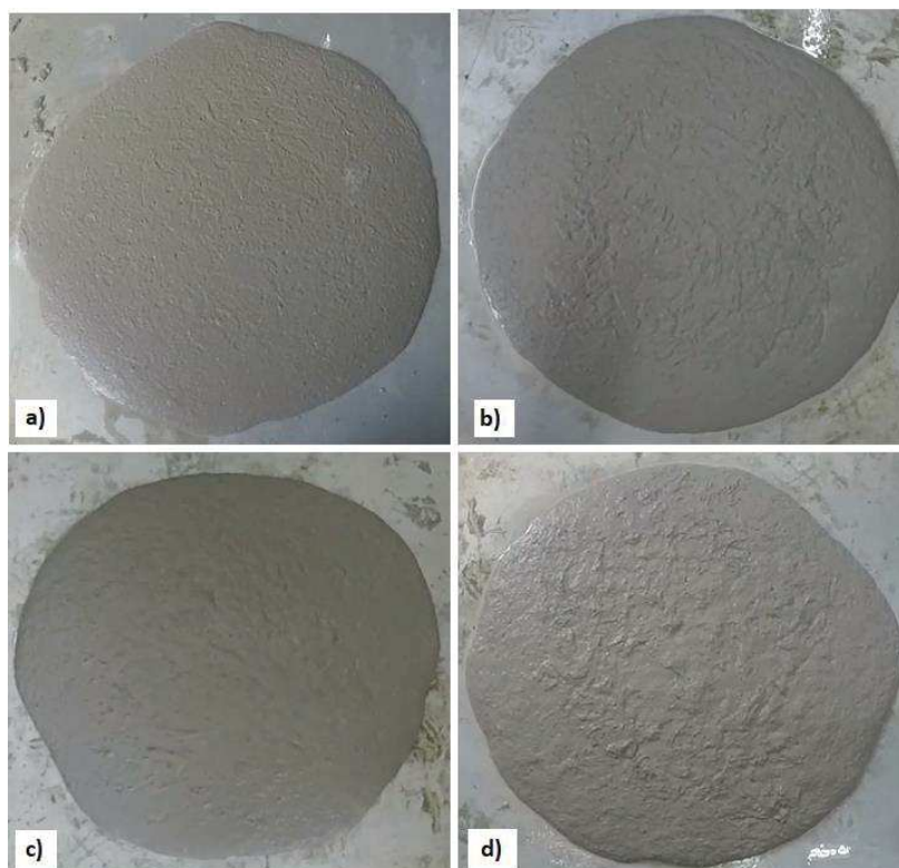
Figura 62 - Espalhamento das misturas, a) Ref.; b) 1% fibras; c) 2% fibras; d) 3% fibras
