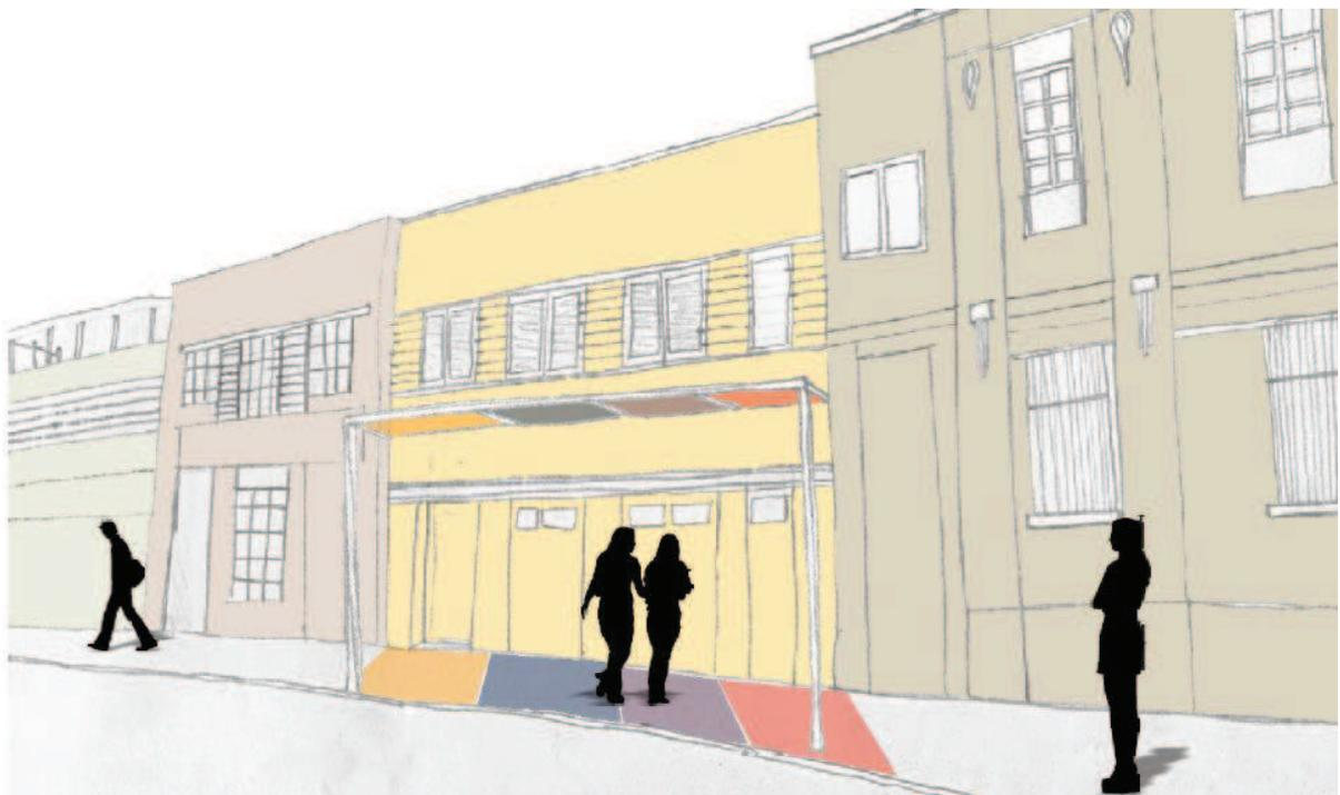
**Figura 116:** Uso de acrílico translúcido nas fachadas.
