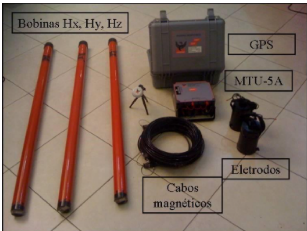
Figura 6: Conjunto de equipamentos magnetotélúricos (MT) da fabricante Phoenix Geophysics utilizados nos levantamentos terrestres. A imagem mostra as principais partes do sistema: bobinas indutivas ( H_x , H_y e H_z ) para aquisição das componentes do campo magnético, receptor
