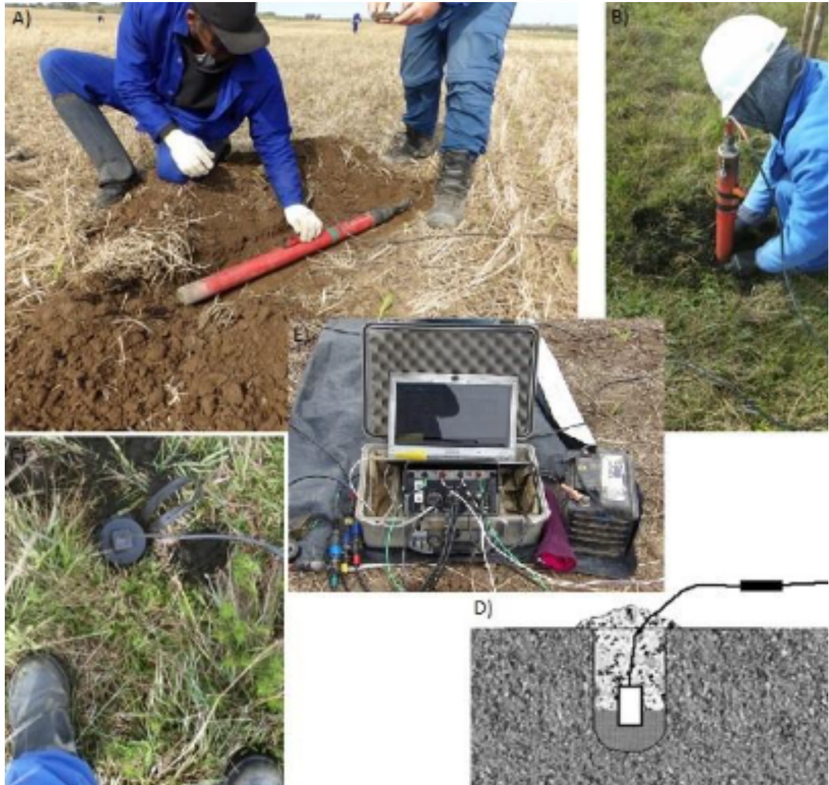
Figura 5: Etapas de instalação de uma estação magnetotelúrica (MT) em campo. a) Nivelamento e alinhamento das bobinas indutivas horizontais responsáveis pelas componentes H_x e H_y . b) Montagem e nivelamento da bobina vertical H_z . c) Preparação e instalação de eletrodos não polarizáveis, utilizando solução salina para otimizar o acoplamento elétrico com o solo. d) Esquema ilustrativo indicando a profundidade e o posicionamento recomendados para os eletrodos em subsuperfície. e) Receptor MTU-5A com todos os canais configurados, integrando sensores magnéticos e dipolos elétricos (adaptado de Lugão, P. P., 2019).
