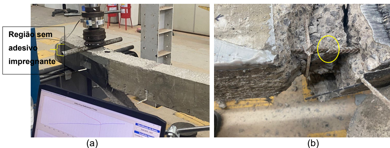
Figura 30 – Detalhe da ruptura da VER_01 e o rompimento da armadura.
