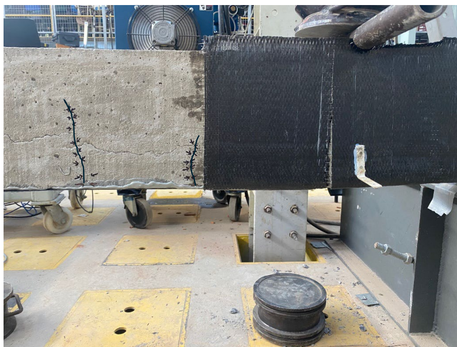
Figura 33 – Detalhe da ruptura da VC_01.
