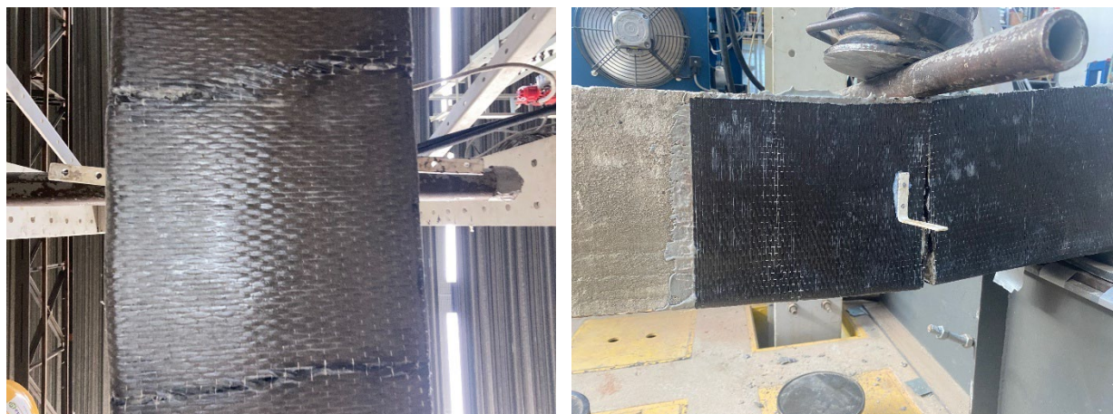
Figura 31 – Detalhe da ruptura da VER_03.
