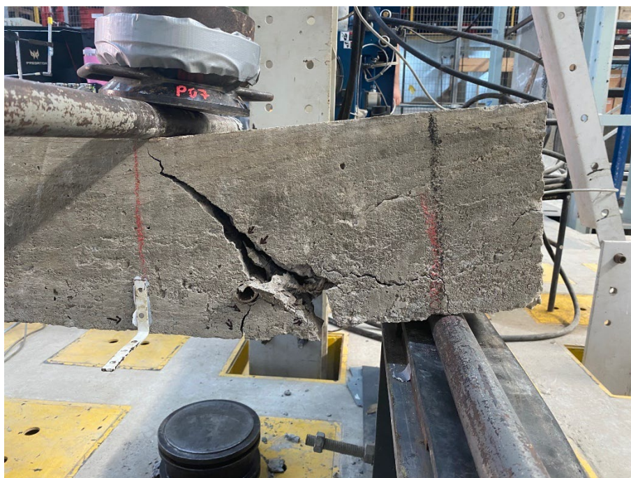
Figura 28 – Ruptura da viga V2 por cisalhamento.
