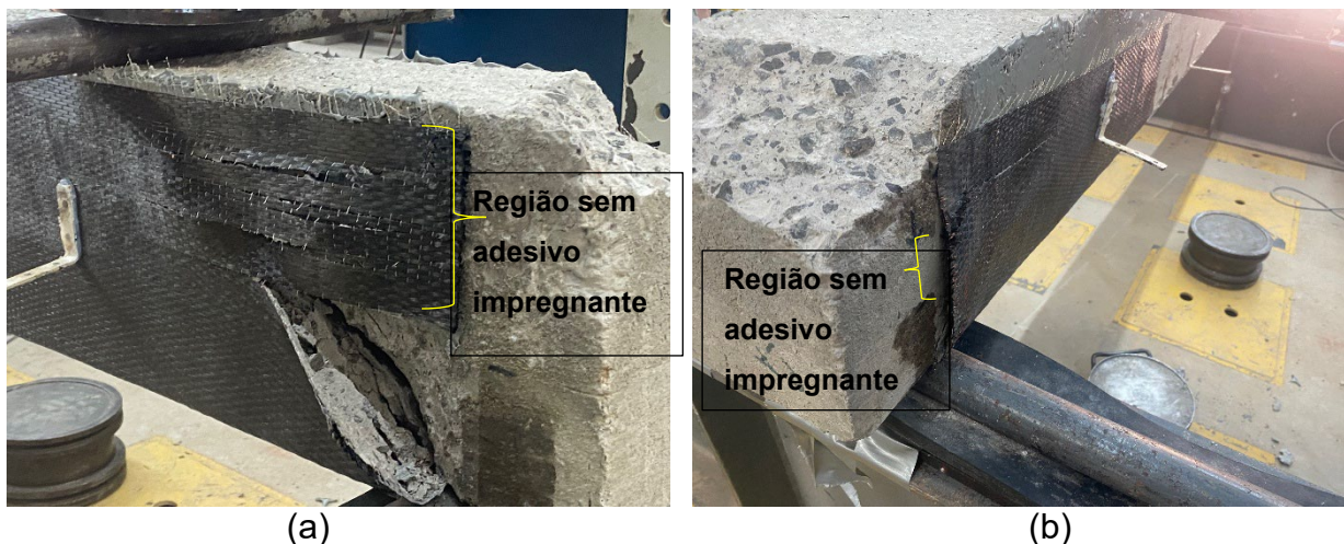
Figura 29 – Detalhe da ruptura da VER_02 e o descolamento da manta.
