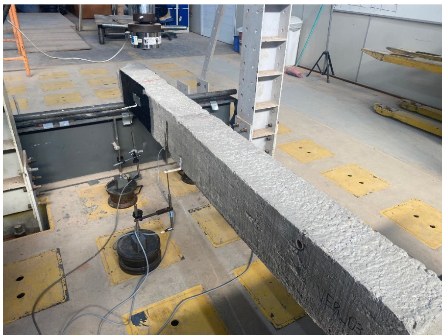
Figura 26 – Exemplo de uma das vigas instrumentadas com os LVDT's.
