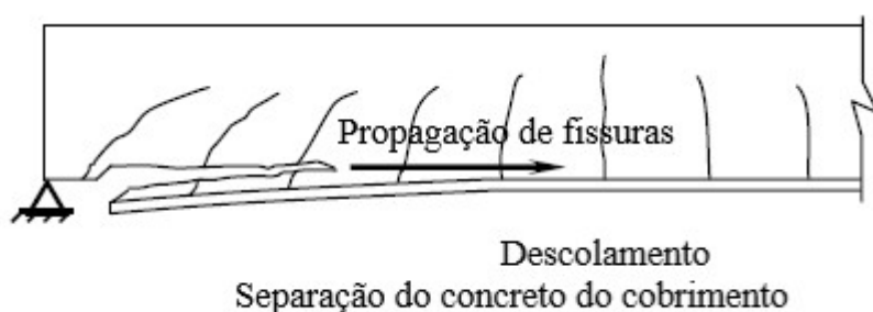
Figura 6 – Ruptura com descolamento interfacial na zona de ancoragem.
