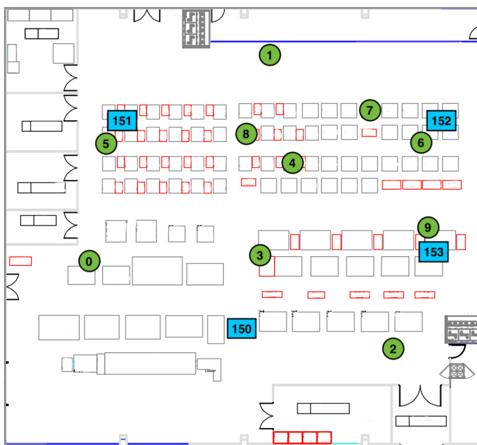
Figura 20 – Planta baixa da sala limpa da HT Micron Semicondutores, onde foram instalados os beacons fixos (retângulos azuis) e definidos os pontos de interesse (círculos verdes).
