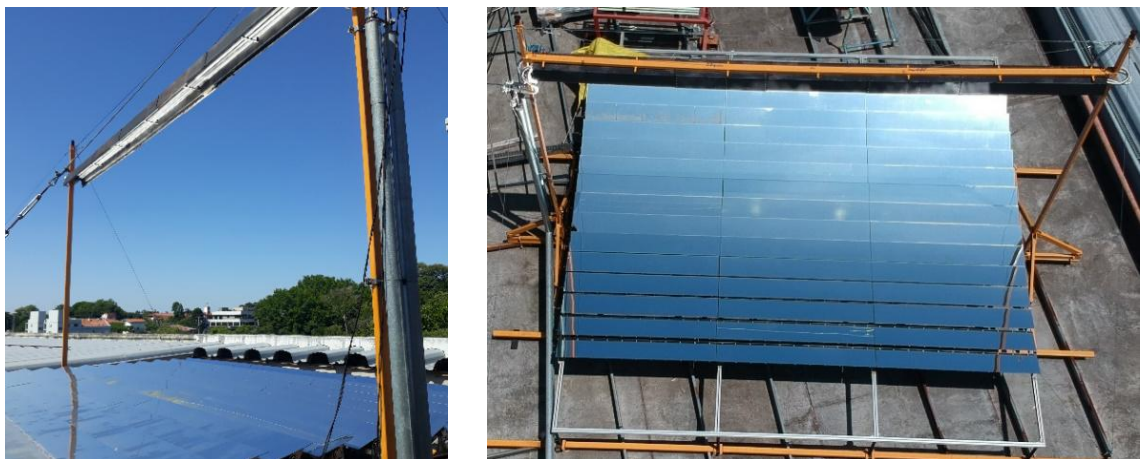
Figura 6.8. Protótipo experimental da bancada LFR do Laboratório de Fontes Renováveis da Unisinos: à esquerda – vista lateral do campo de espelhos e cavidade receptora; à direita – vista superior do campo de espelhos.
