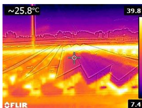
Figura 7.23 Visualização da sombra projetada do receptor no campo de espelhos a partir da câmera térmica.
