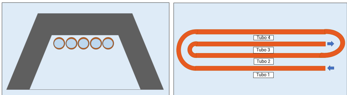
Figura 6.7 Representação do receptor do modelo teórico: à esquerda, vista frontal do receptor e; à direita, a representação dos tubos absorvedores em formato de serpentina.
