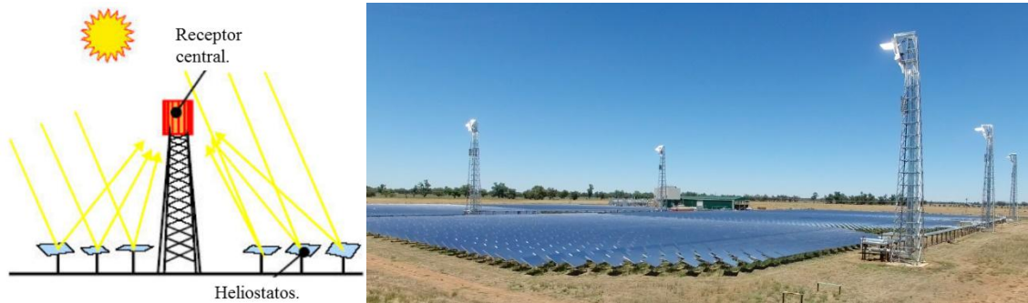
Figura 2.4. (a) Representação dos componentes de um sistema de concentradores HFC; (b) Projeto HFC desenvolvido pela VastSolar, localizado na Austrália.
