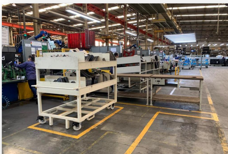
Figura 38 – Carros kits em testes na linha de solda.
