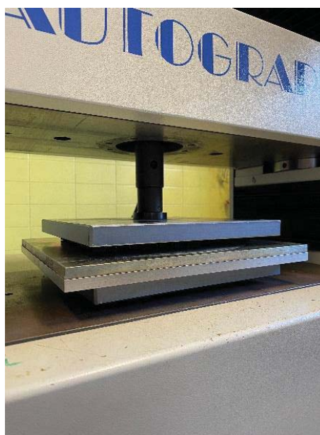
Fotografia 8 – Aparato para medição da resistência à compressão dos aglomerados de borracha
