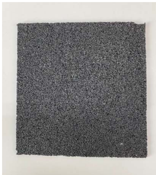
Fotografia 2 – Amostra de aglomerado de borracha com 200x200 mm
