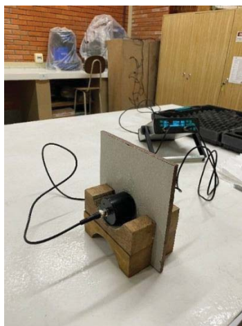
Fotografia 5 – Configuração do ensaio de medição da velocidade de transmissão de onda ultrassônica
