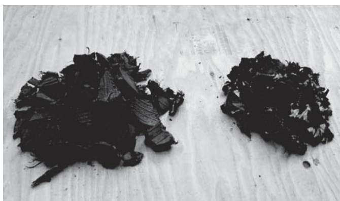
Figura 19 – Borracha de pneus granulada do tipo com (esquerda) e sem (direita) fibras metálicas ou têxteis
