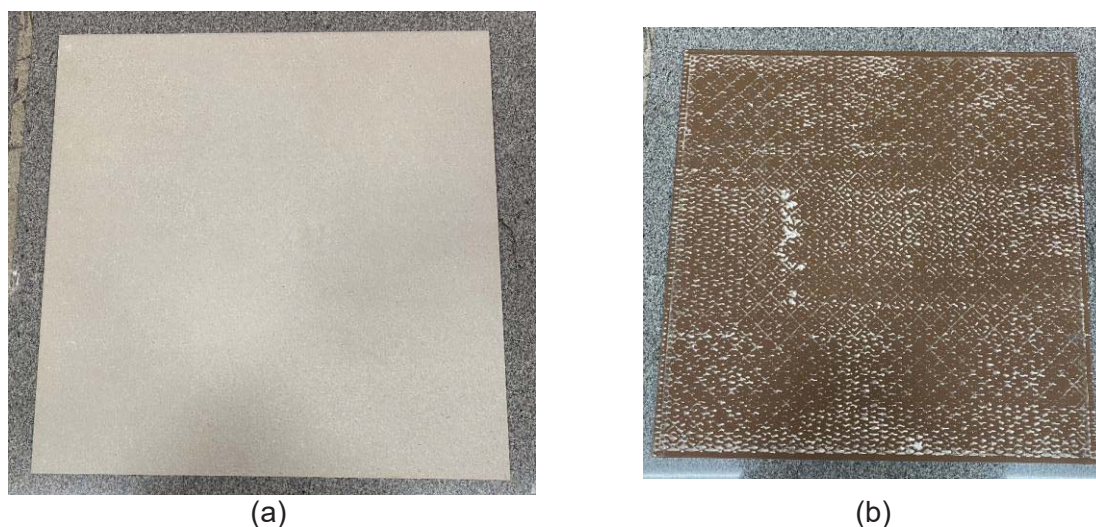
Fotografia 3 – Piso de porcelanato, face: (a) superior, e (b) inferior
