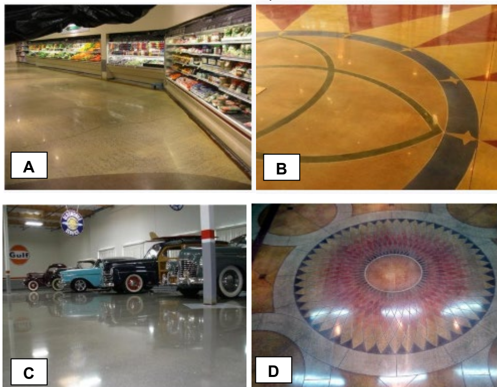
A – Concreto lapidado manchado; B – Concreto lapidado tingido; C – Concreto lapidado cinza simples; D – Concreto lapidado com ranhuras e padrões.
