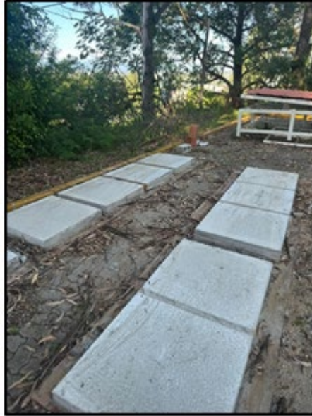
Figura 32 – Placas de concreto sem tratamento, após 28 dias de cura e preparadas para receber os tratamentos superficiais
