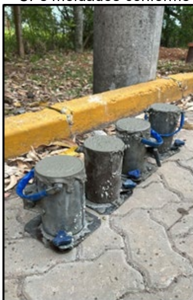
Figura 37 - CPs moldados conforme NBR 5738
