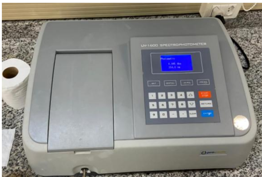
Fotografia 7 - Espectrofotômetro – UV1600 – Pro-tools utilizado no ensaio de DQO
