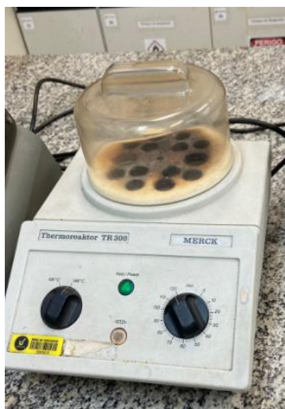
Fotografia 6 - - Termoreator – TR300 – Merck utilizado no ensaio de DQO
