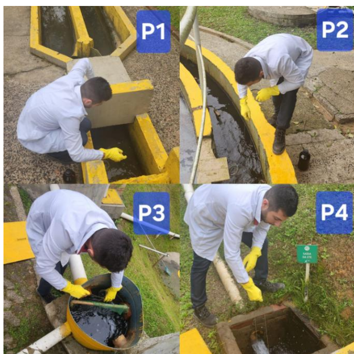
Fotografia 3 – Coleta de amostras de efluente na ETE nos respectivos pontos: P1, P2, P3 e P4.
