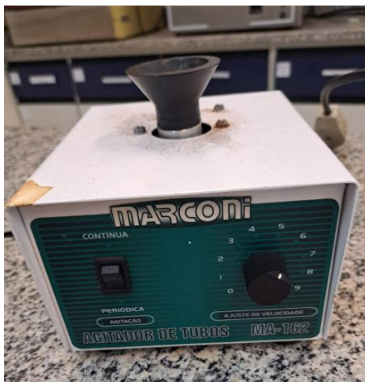
Fotografia 5 – Vórtex – MA-162 – Marconi utilizado no ensaio de DQO
