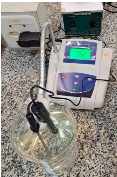
Fotografia 8 - pHmetro – PHB-550 – Incoterm utilizado para as medidas do parâmetro pH
