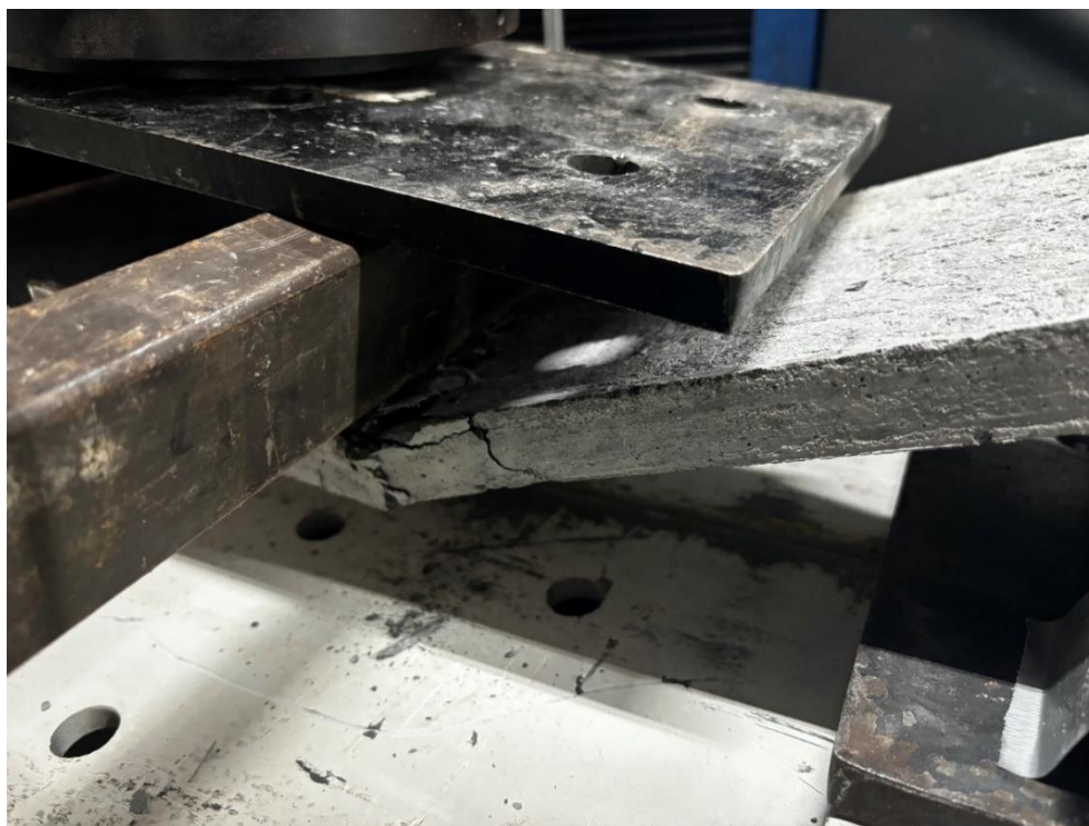
Figura 59 – Grande deformação da amostra, ainda sob elevação de carregamento
