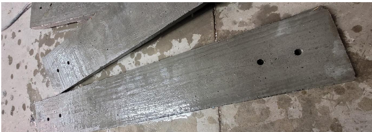
Figura 28 – Chapas concretadas e deformadas, indo para cura térmica
