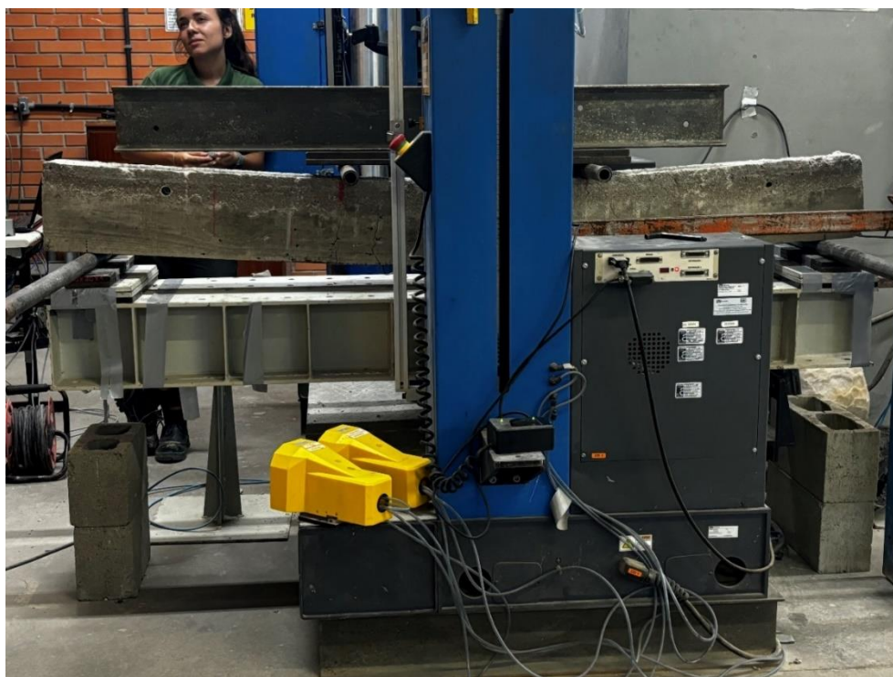
Figura 40 – Deformação da viga
