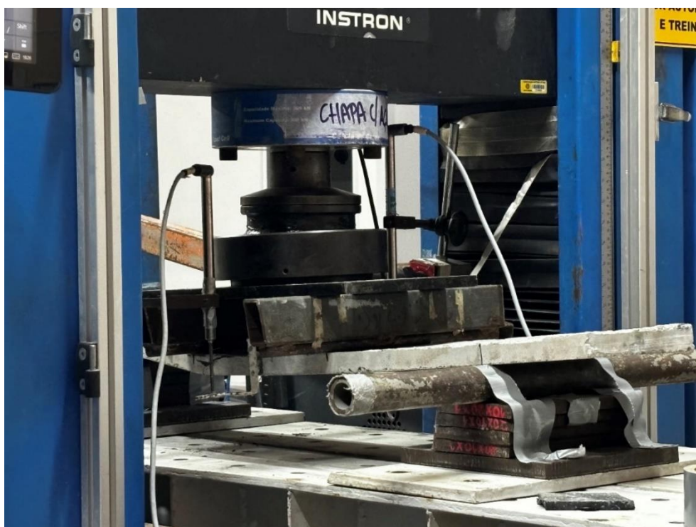
Figura 57 – Deformação inicial da amostra, já com fissuração central
