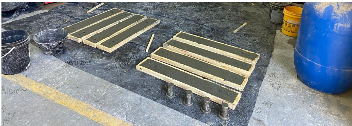
Figura 27 – Chapas de UHPC concretadas
