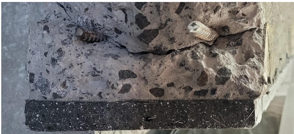
Figura 61 – Colagem bem realizada na amostra 01, que apresentou melhor desempenho no estado limite de serviço do que a da figura anterior
