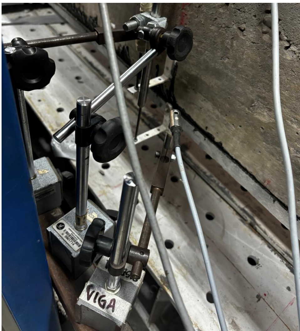
Figura 34 – LVDT's posicionados no centro das amostras, medindo deslocamentos
