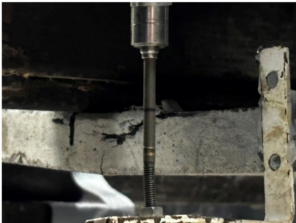
Figura 58 – Fissuração inferior e esmagamento superior da amostra
