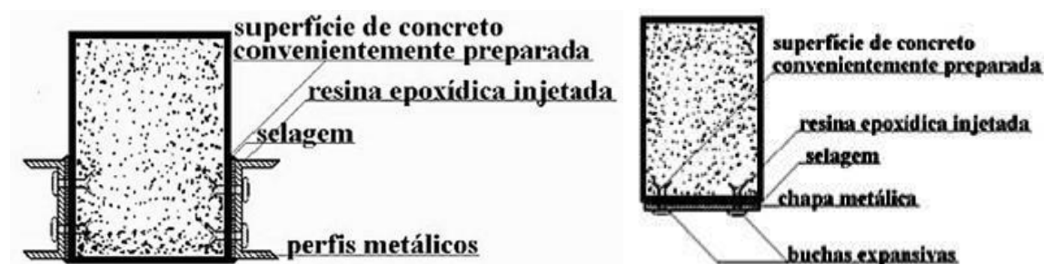
Figura 5 – Reforços de vigas à flexão com chumbamento de perfis (à esquerda) e chapas (à direita) metálicas
