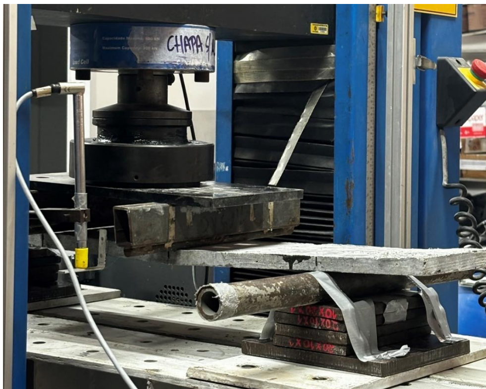
Figura 55 – Deformação inicial da chapa, já com fissuração central
