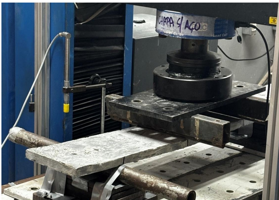
Figura 56 – Deformação inicial da chapa, já com fissuração central
