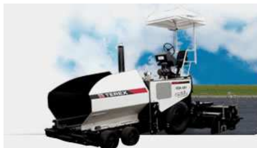
Figura 3 – Vibroacabadora de Asfalto Bomag Fonte: Bomag Marini, 2013.
