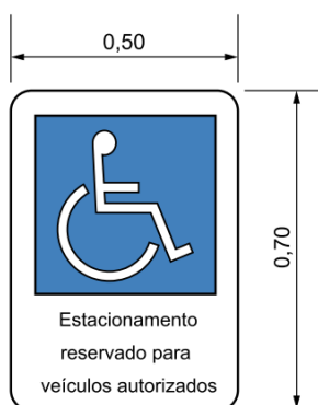
Figura 13 - Sinalização vertical para vagas reservadas às PCD
