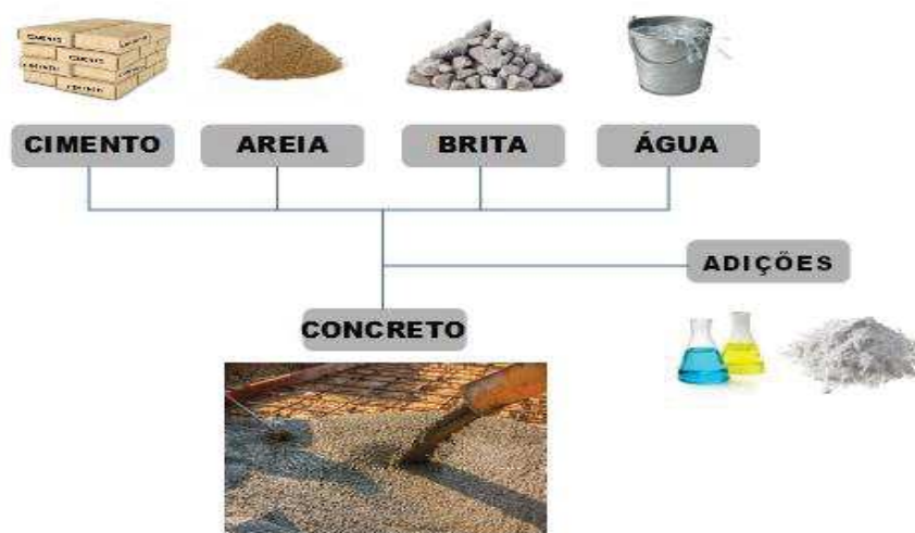
Figura 3: Composição Básica do Concreto
