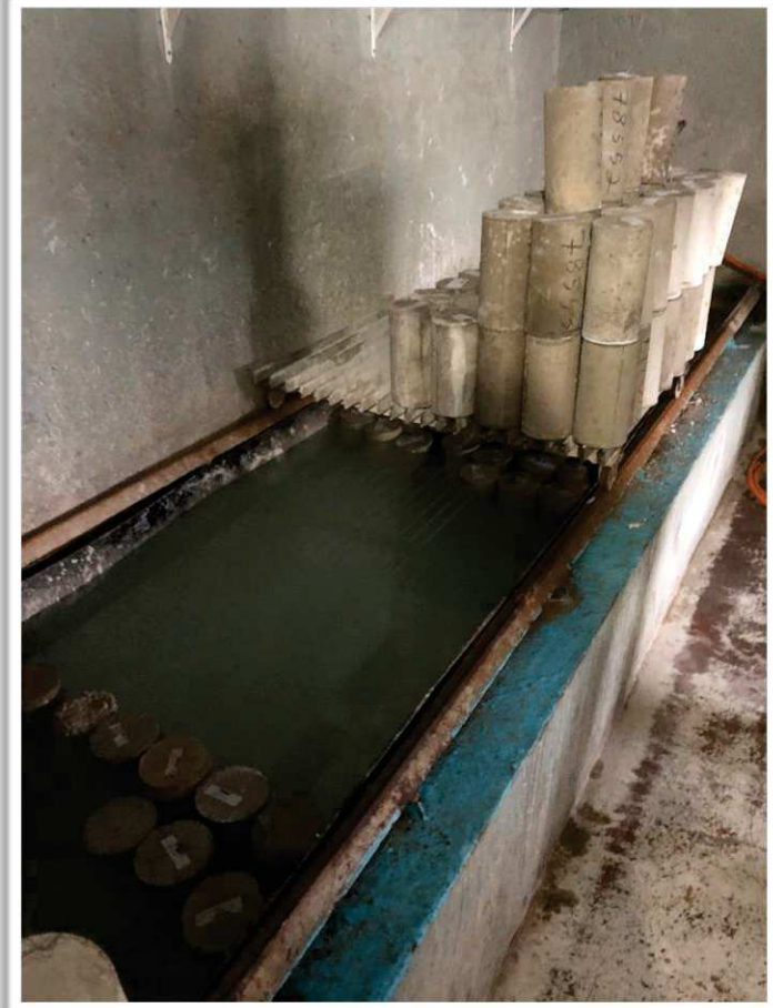
Fotografia G: Tanque de cura dos corpos de prova
