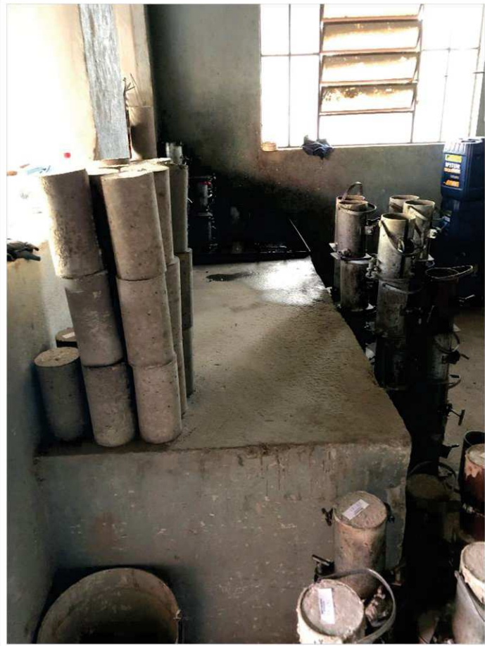
Fotografia F: Laboratório de corpo de provas de resistência do concreto
