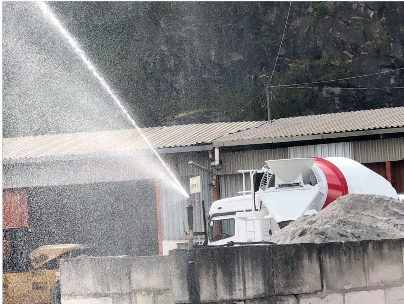
Fotografia O: Irrigador de água para o pátio de passagem dos caminhões e máquinas
