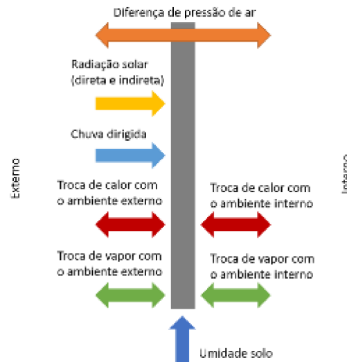
Figura 1 - Esquema das cargas higrotérmicas que agem na parede externa e suas alterações direcionais
