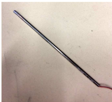
Figura 3.8 – Termopar tipo E encapsulado
