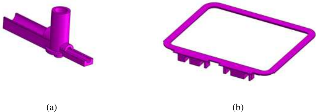
Figura 4.22 – Dispositivos para montagem da seção de testes: (a) conexão de entrada/saída para instrumentação; (b) o-ring
