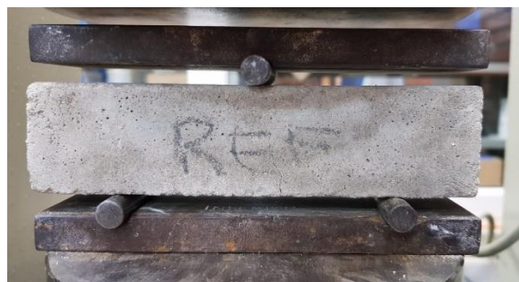
Figura 27 – Aspecto da ruptura da amostra de referência após o ensaio de resistência à tração na flexão
