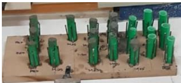
Figura 21 – Moldes das argamassas para o ensaio térmico
