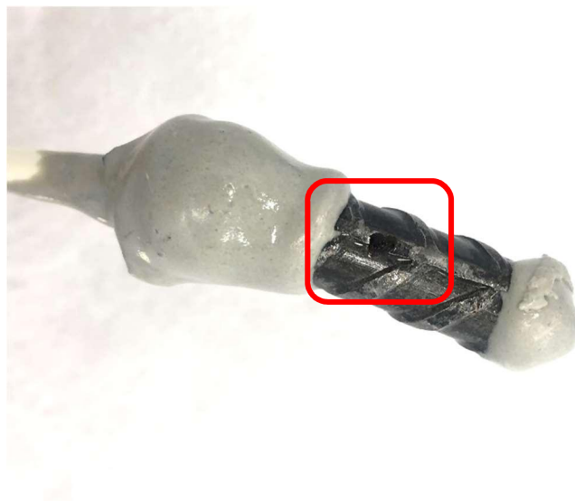
Figura 25: Amostra 136SC080 com formação de pite de corrosão.
