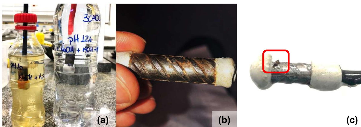
Figura 24: (a) comparação entre a amostra 100SP000 (com corrosão generalizada) e 126SP000 (corrosão por pites), (b) eletrodo 100SP000 após limpeza, com corrosão generalizada e (c) eletrodo 126SP000 com pite de corrosão.
