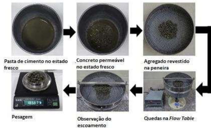
Figura 9- Teste para avaliar a espessura de pasta na superfície do agregado
