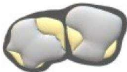
Figura 73 – Pasta de cimento envolvendo os agregados reciclados, sem a realização de adensamento
