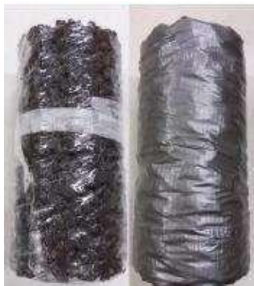
Figura 63 – Preparação dos corpos de prova para o ensaio de permeabilidade
