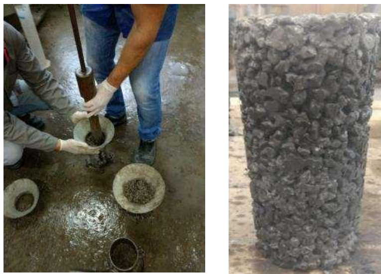
Figura 60 – Compactação dos corpos de prova 10Ø x 20 cm com a utilização do soquete Proctor 2,5 kg.
