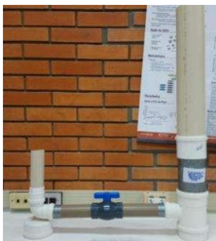
Figura 62 - Montagem do permeâmetro
