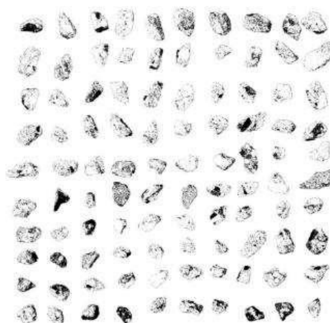
Figura D4– Identificação no AGRC da parte correspondente a argamassa e ao agregado natural
