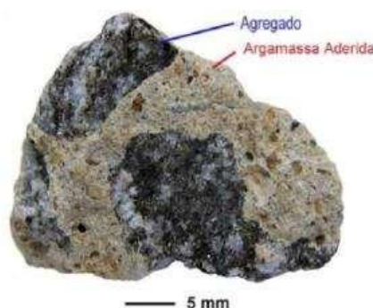
Figura 3 - Argamassa aderida no agregado natural
