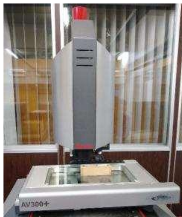
Figura 49 – Posicionamento das hastes de argamassa na máquina Tridimensional Óptica
