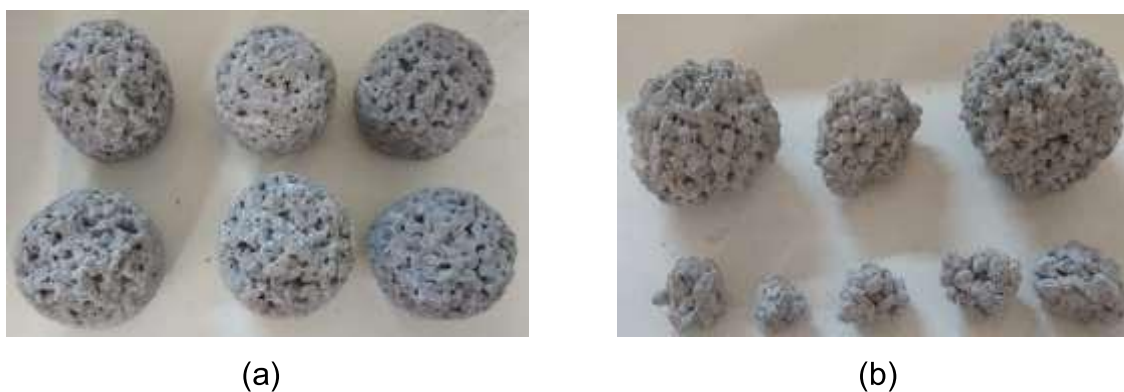
Figura 84 – Formato dos corpos de prova de concretos permeáveis após serem submetidos ao ensaio de abrasão
