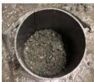
Figura 74 – Diferentes formas de acontecer a desintegração do agregado reciclado, em virtude do processo de compactação
