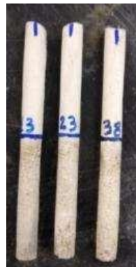
Figura 47 – Hastes utilizadas no ensaio para a determinação da rugosidade nas argamassas.
