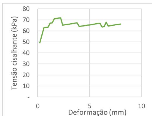
Figura 28 Tensão cisalhante versus deformação para tensão normal de 100 kPa para o *liner* 3.
