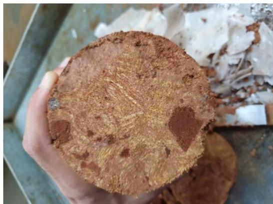
Figura 54 Amostra indeformada da última campanha de monitoramento do *liner 1*.
