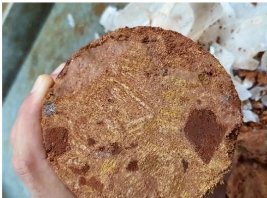
Figura 55 Amostra indeformada da última campanha de monitoramento do *liner 1*.
