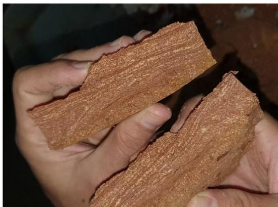
Figura 53 Amostra indeformada da última campanha de monitoramento do *liner 1*.
