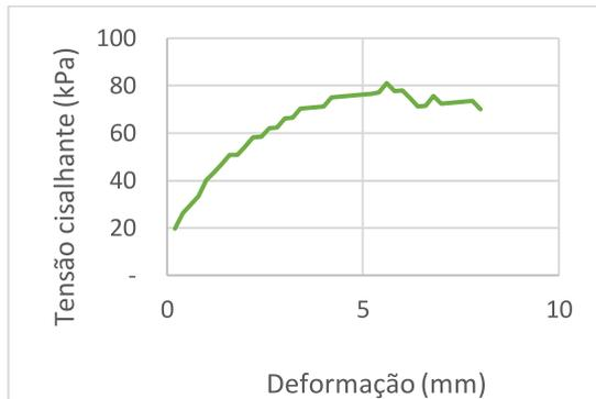
Figura 32 Tensão cisalhante versus deformação para tensão normal de 100 kPa para o *liner* 4.
