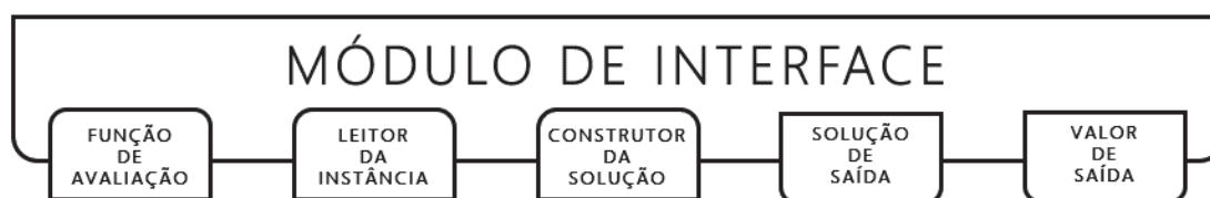
Figura 22 – Arquitetura do Bloco de Interface
