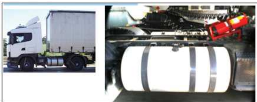
Figura 23: Aplicação dos Tanques de Combustível Fonte: Schmidt (2014)
