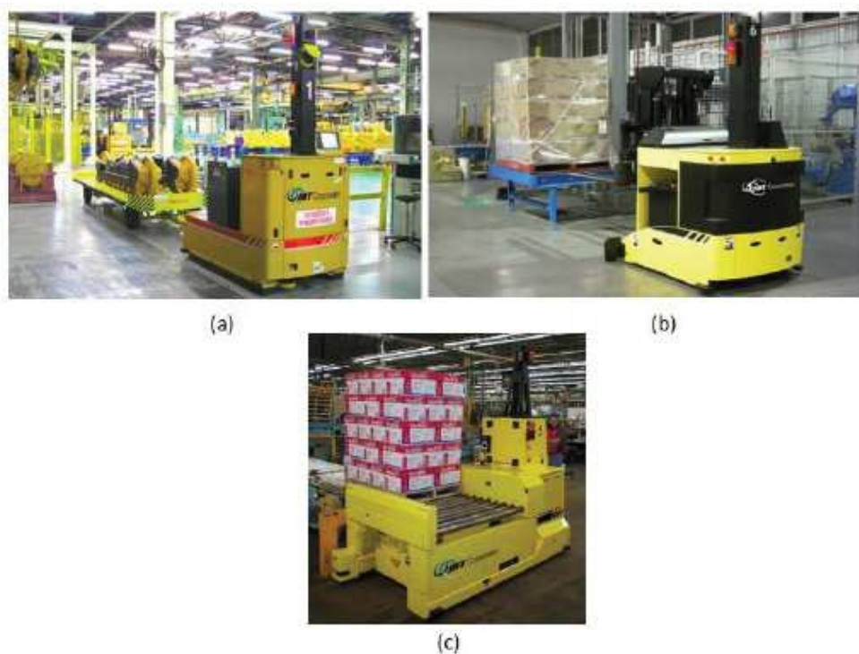
Figura 29: (a) Trem Sem Condutor, (b) Transportador de Pallets , (c) Transportador de Carga Unitária Fonte: Senai (2018)
