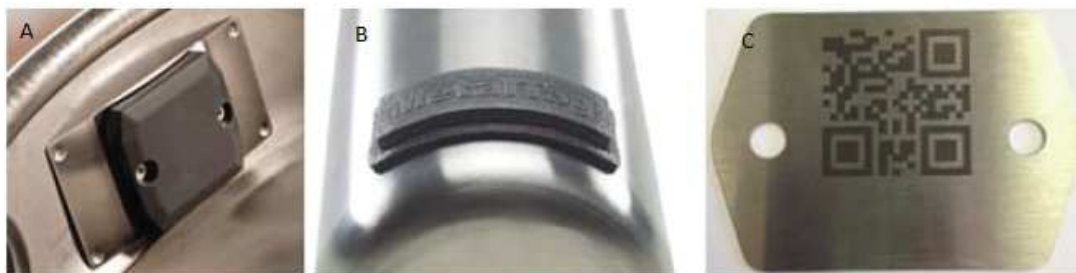
Figura 32: a) Etiqueta de RFID Fixadas no Metal, b) Outro Modelo de Etiqueta de RFID Fixadas no Metal e c) QR code Marcado no Metal
