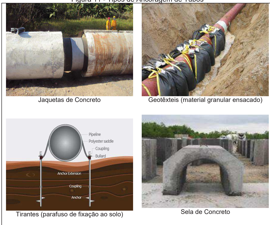
Figura 11 - Tipos de Ancoragem de Tubos
