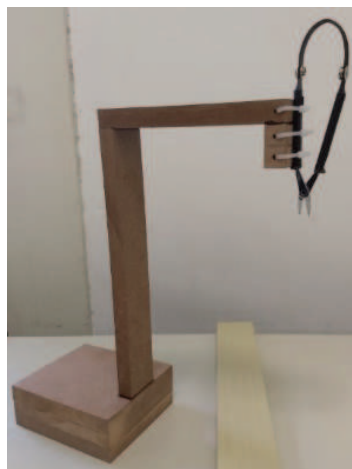
Figura 3.27 - Equipamento de teste para determinação do coeficiente de restituição partícula-parede.
