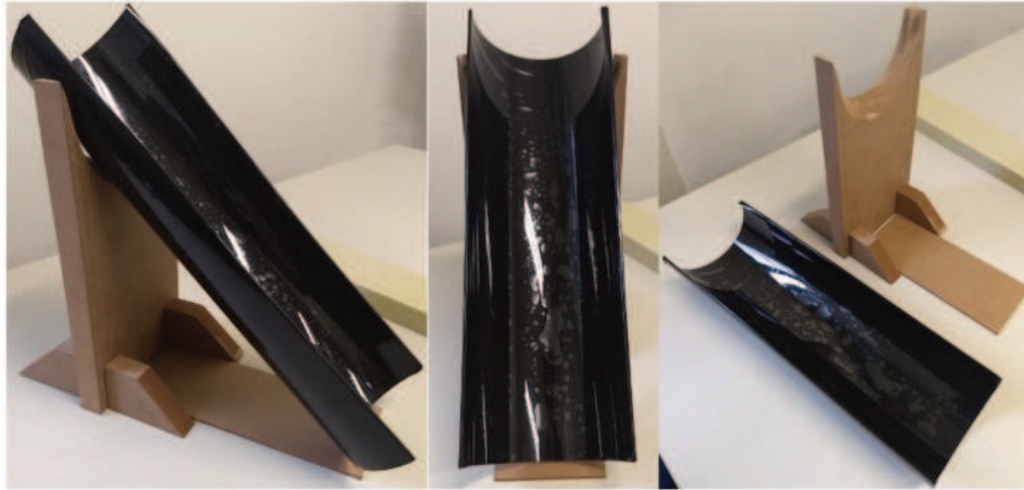
Figura 3.22 - Teste para determinação do coeficiente de atrito dinâmico partícula-parede.
