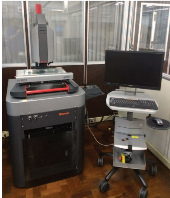
Figura 3.8 - Equipamento tridimensional de análise e medição de imagens da marca Starrett, modelo Galileo AV 300+ automático.
