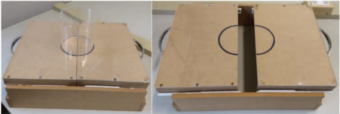
Figura 3.23 - Equipamento para realização dos testes de ângulo de repouso e ângulo drawdown.
