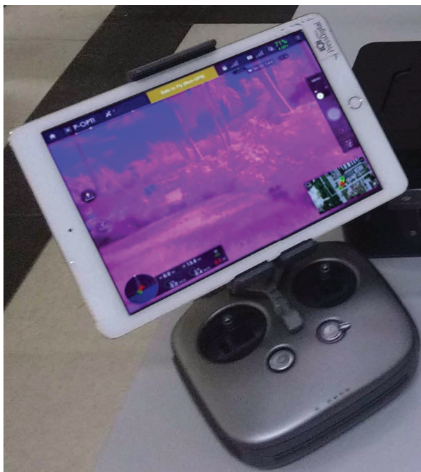
Fotografia 6 – Controle com programa executando o modo de efeito digital de visão
