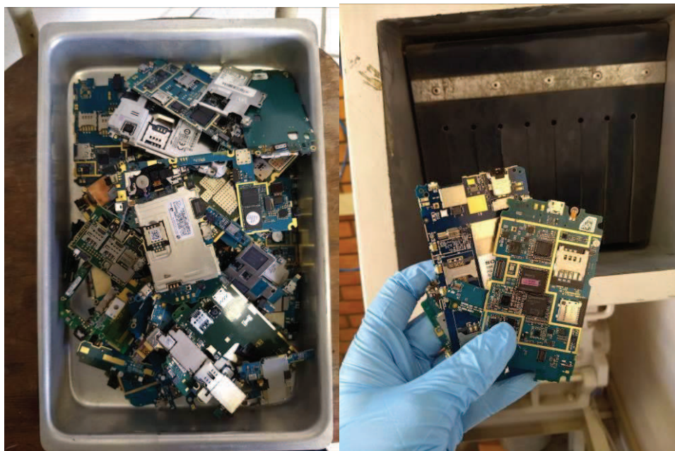
Figura 17 e Figura 18 – Moagem de placas de circuito impresso em moinho de facas
