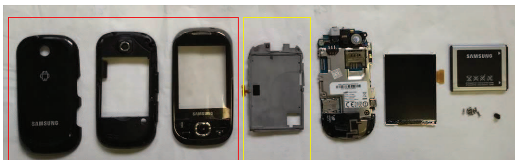
Figura 28 – Partes de carcaça externa (em vermelho) com uma peça de carcaça interna (cor amarela)
