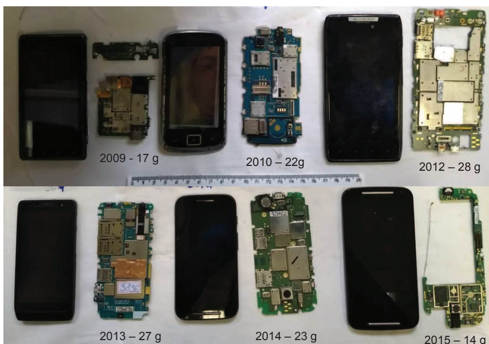
Figura 29 – Comparação de tamanhos e massas de placas de circuito impresso ao longo dos anos de fabricação da fabricante Motorola
