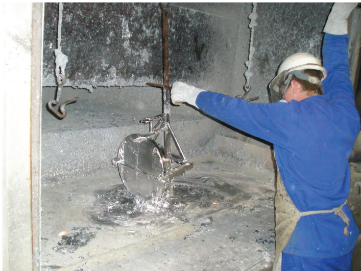
Figura 18: Processo de zincagem.
