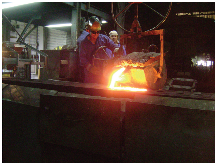
Figura 9: Processo de vazamento dos moldes.
