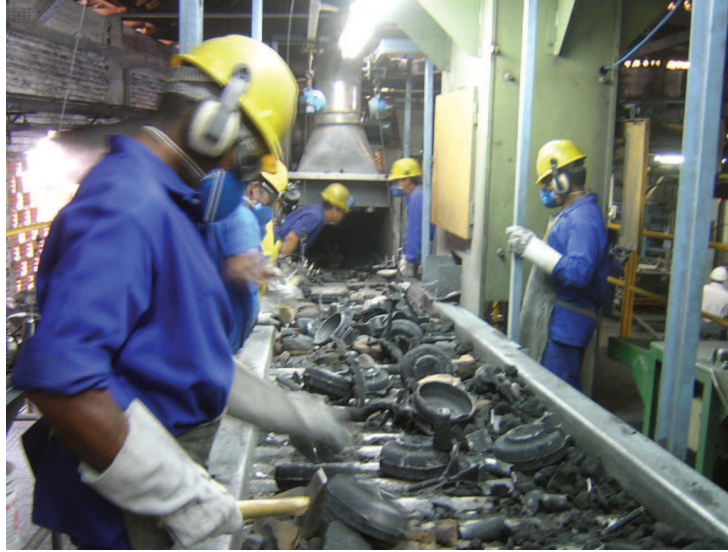
Figura 12: Processo de quebra de canais.
