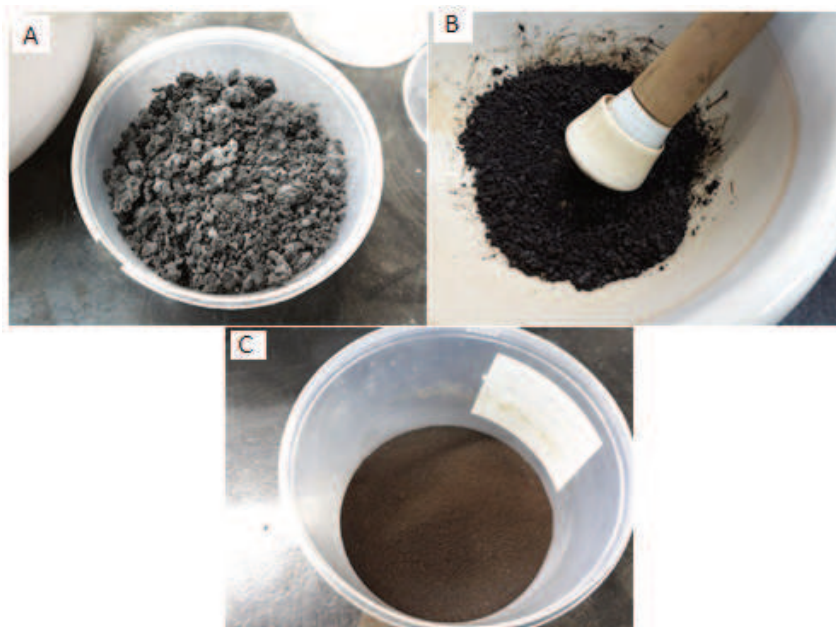
Figura 15 – Secagem (A), processo de moagem (B) e LF moído (C)
