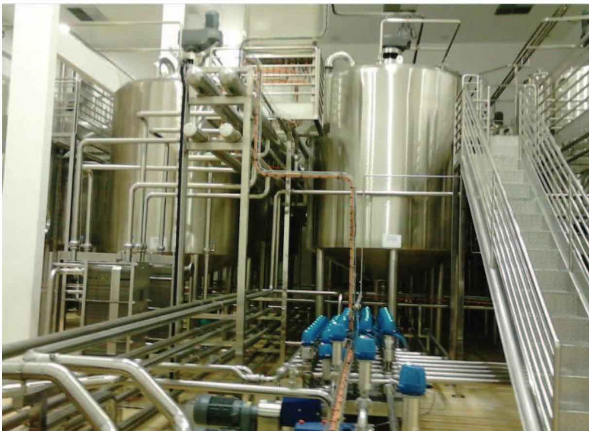
Figura 21 – Tanques de Armazenamento de Fermentados
