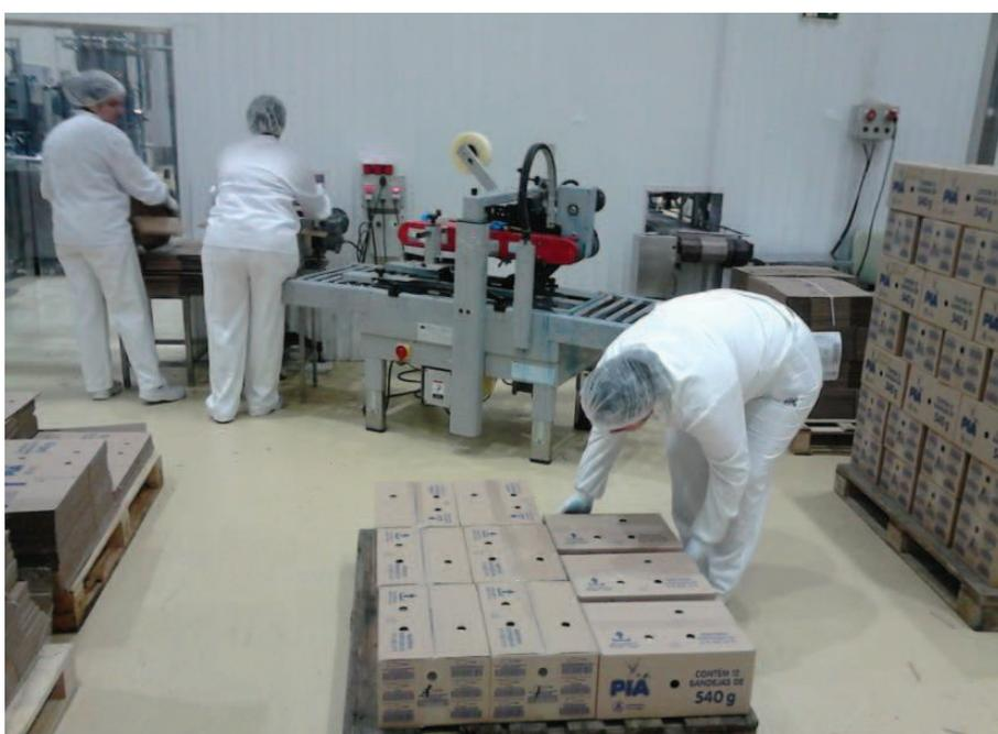
Figura 25 - Acondicionamento em caixas de papelão e paletizados
