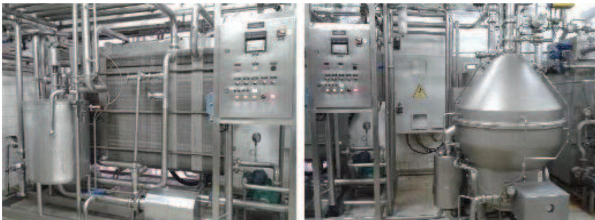
Figura 14 – Equipamentos de Pasteurização e Centrifugação
