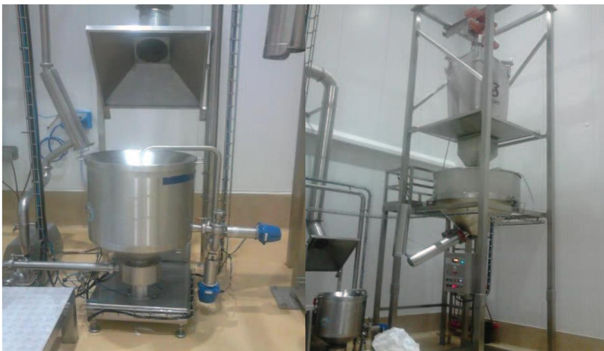
Figura 17 – Equipamento Almix e Dosador de açúcar
