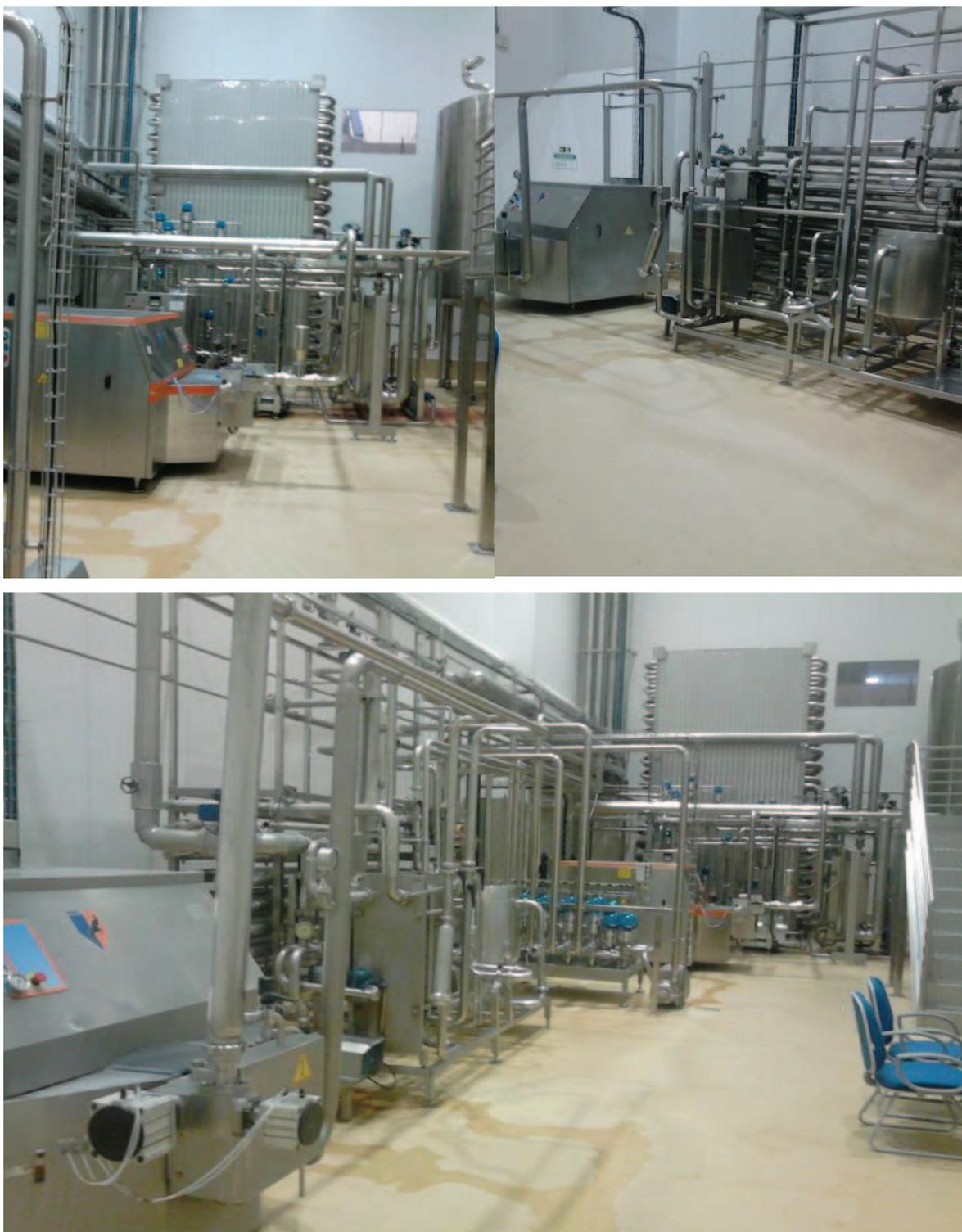
Figura 19 – Pasteurizador e Homogeneizador de Fermentados
