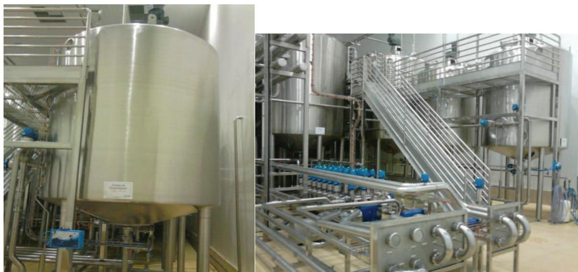
Figura 18 – Tanques de Fermentação de Iogurtes e Bebidas Lácteas
