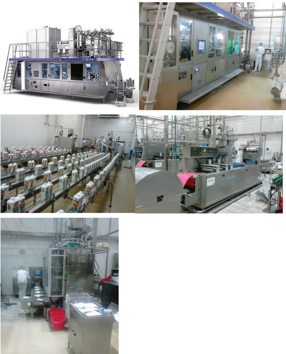
Figura 24 – Máquinas de envase de fermentados em garrafas, Saco, bandejas e em cartonados.
