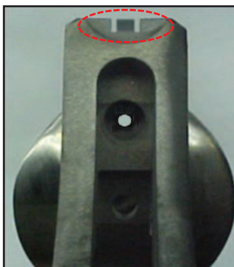
Figura 9 – Alinhamento do conjunto cano e armação
