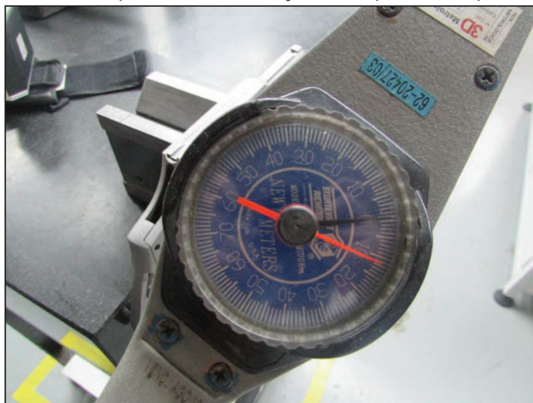
Figura 48 – Torquímetro de calibração do dispositivo de pré-torque
