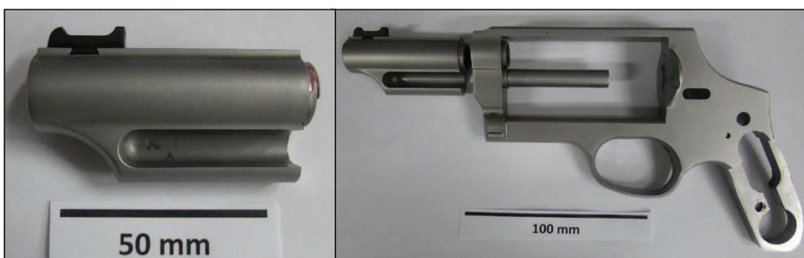
Figura 10 – Modo de Falha Cano Quebrado
