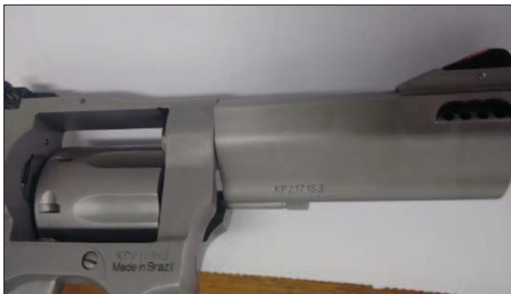
Figura 11 – Modo de Falha Cano Frouxo
