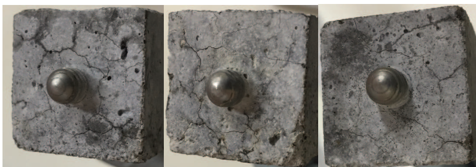
Figura 43 – Aspecto das barras de argamassa PQ após o ensaio acelerado
