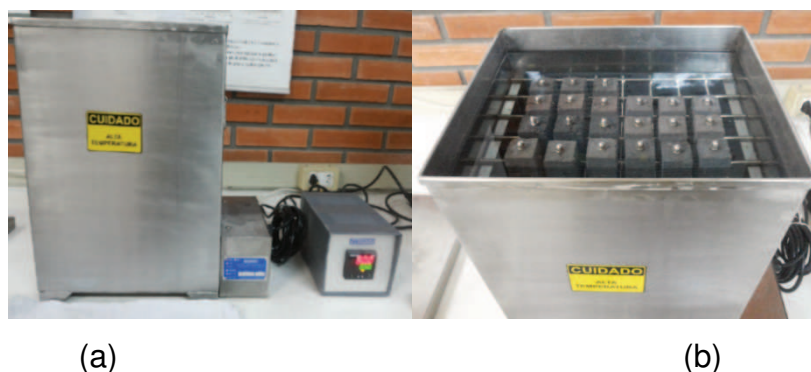
Figura 21 – (a) Banho termorregulador. (b) Barras de argamassa verticalmente introduzidas no banho.
