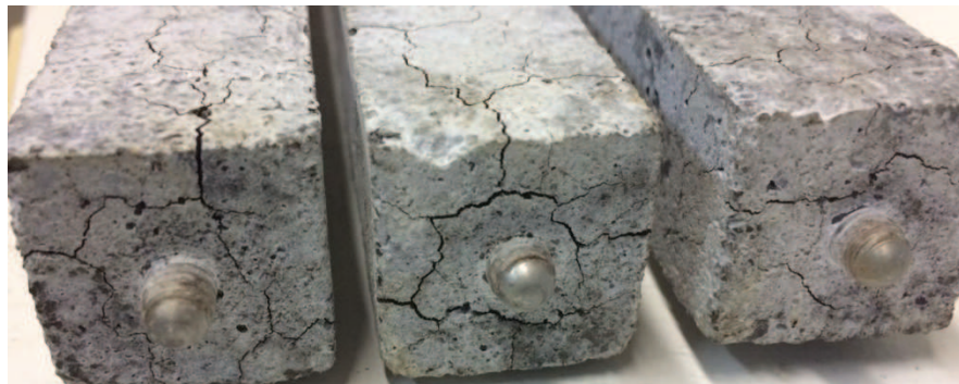
Figura 40 – Aspecto das barras de argamassa REF após o ensaio acelerado
