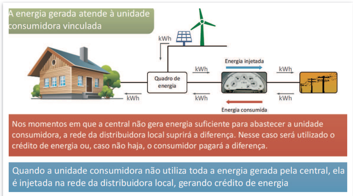
Figura 2. Sistema de Compensação de energia elétrica
