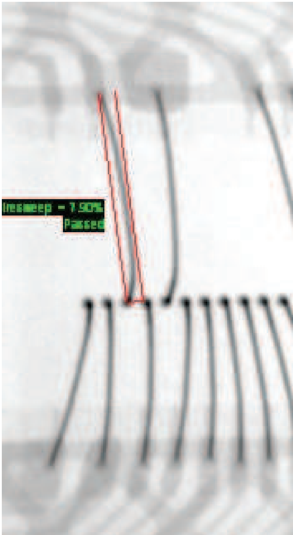
Figura 16 – Medição da taxa de wire sweep utilizando o equipamento de Raio-X
