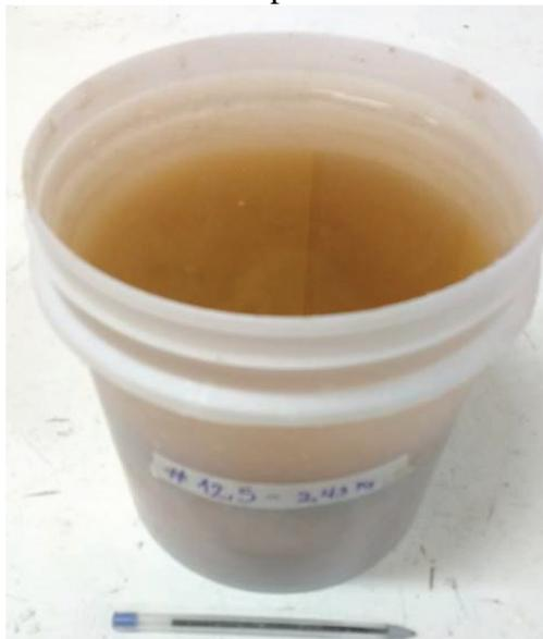
Figura A2 – Peneiramento do AGRC após tratamento pozolânico
