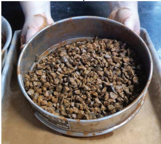
Figura A3 – Tratamento pozolânico realizado separadamente para cada fração granulométrica
