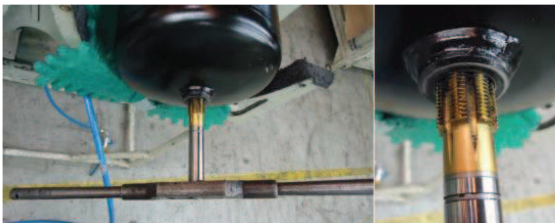
Figura 51 – Foto do processo de retrabalho com macho laminador.
