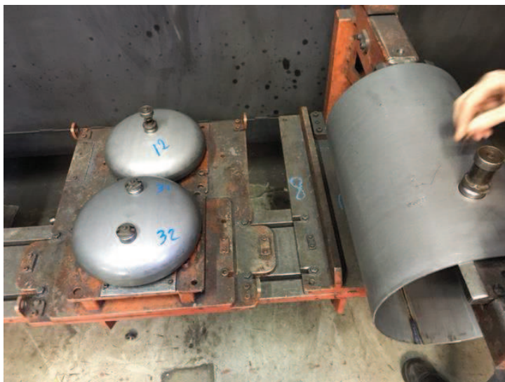
Figura 19 – Foto da medição de GAP de solda com lâminas de calibração.
