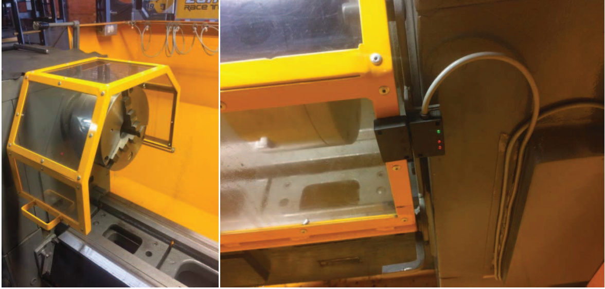
Figura 11 - Proteção da placa universal e intertravamento
