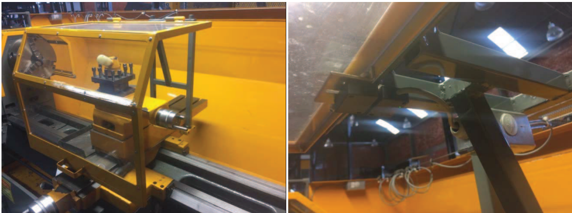
Figura 12 - Proteção do carro principal e intertravamento
