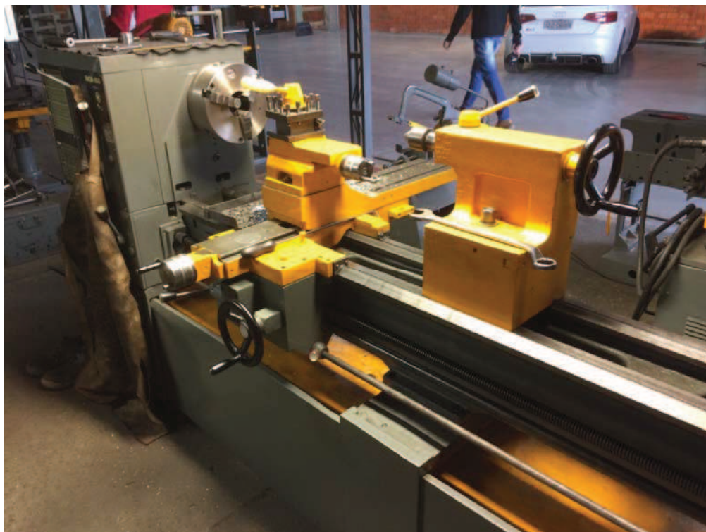
Figura 5 - Torno mecânico Imor-650 antes da adequação (vista frontal)
