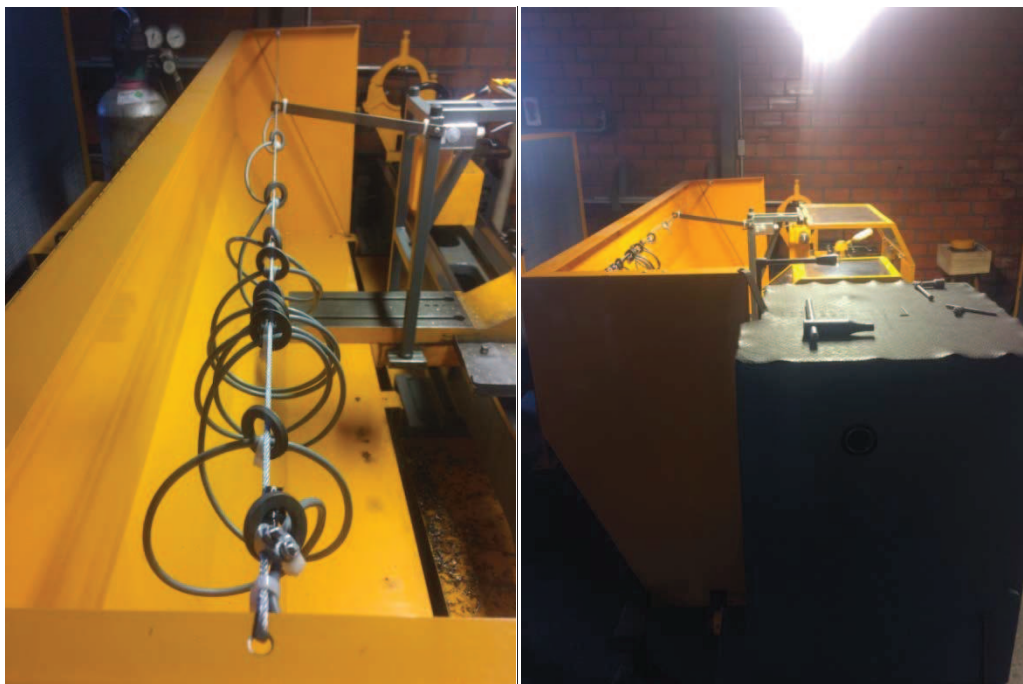
Figura 14 - Proteção da parte posterior do torno mecânico
