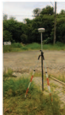
Fotografia 4 – Rastreio GNSS estático
