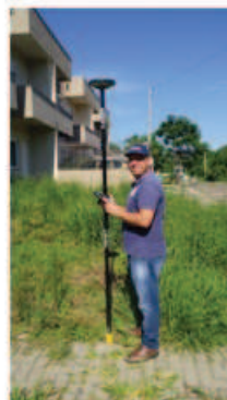
Fotografia 6 – Rastreio GNSS modo RTX
