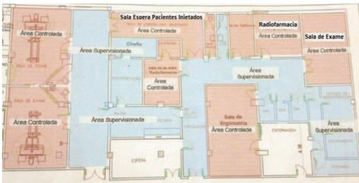
Figura 1 – Planta do local com a classificação de áreas
