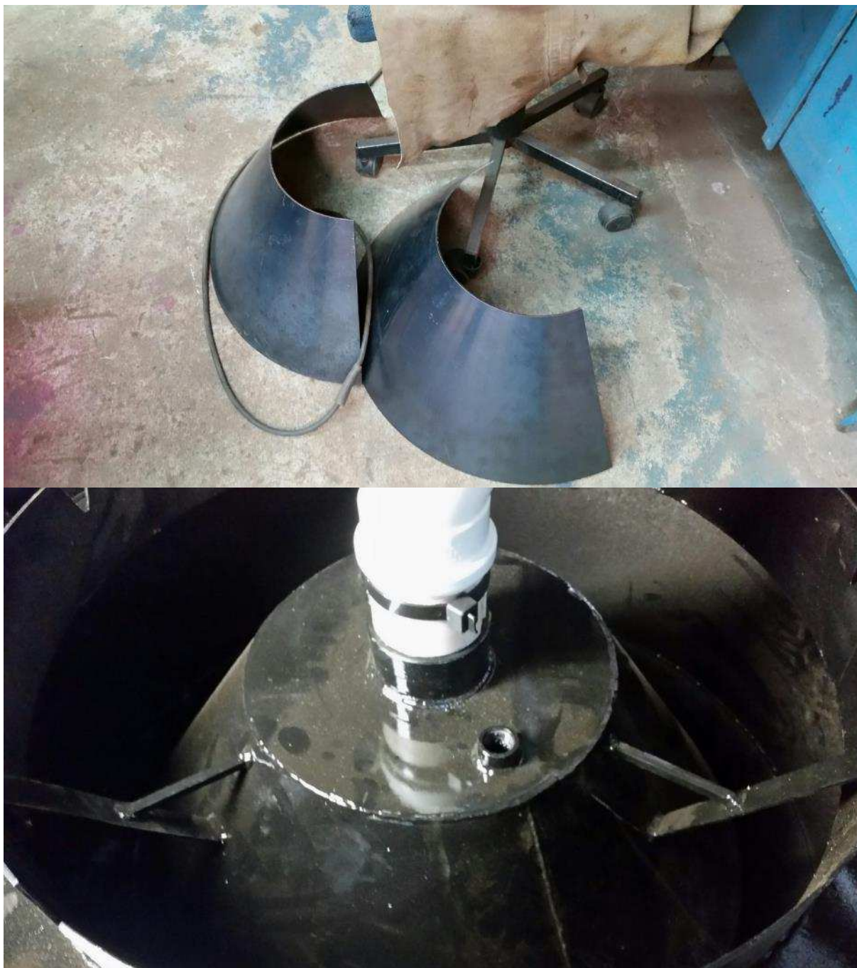
Figura 10 – Separador Trifásico do reator UASB
