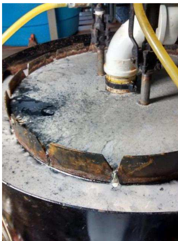
Figura 28 – Acúmulo de espuma após a adição de RSR ao reator
