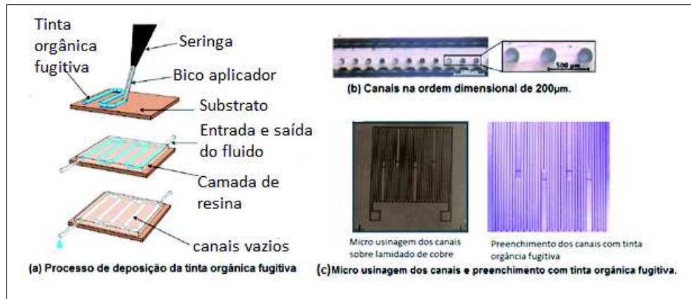
Figura 30 – Microcanais construídos em dielétrico de FR4.
